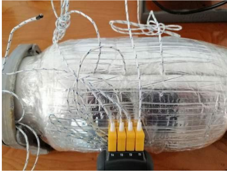
Şekil 5.2: Yığın etrafında yapılan izolasyon
