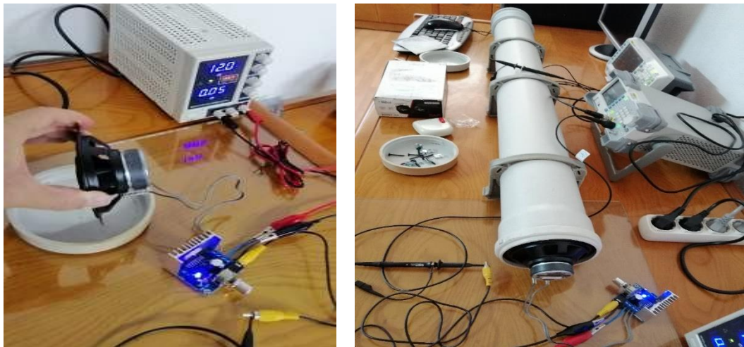
Şekil 4.13: Akustik kaynak için ideal çalışma değerlerinin incelenmesi.
