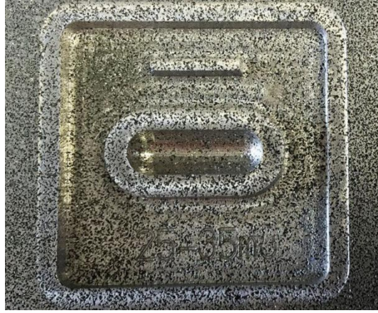
Şekil 3.16: Alüminyum köpük döküm kalıbı örneği (Exxentis 2021).
