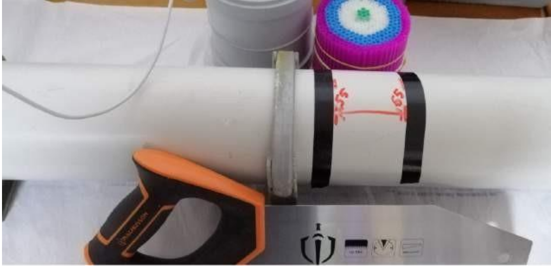
Şekil 4.29: Rezonans tüpünün yığın yerleşimine uygun hale getirilmesi.
