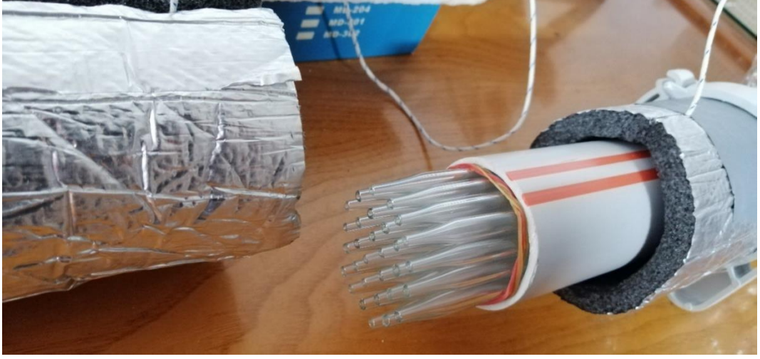
Şekil 5.25: Daralan kesitli cam yiğının görünümü.
