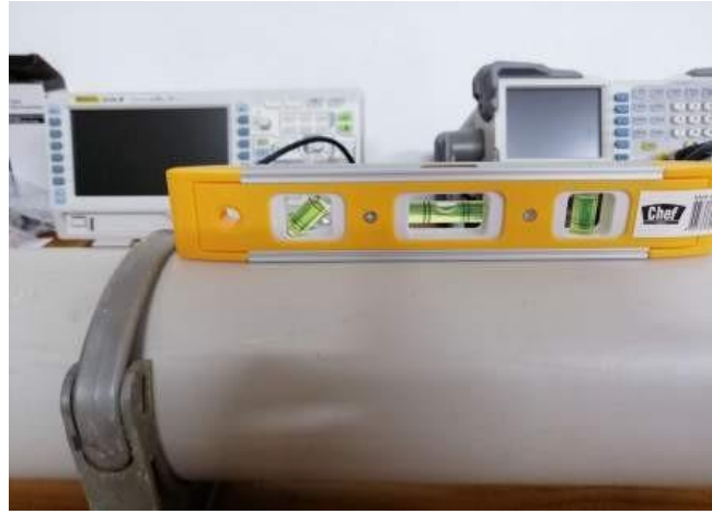
Şekil 4.17: Rezonans tüpünün dengelenmesi.
