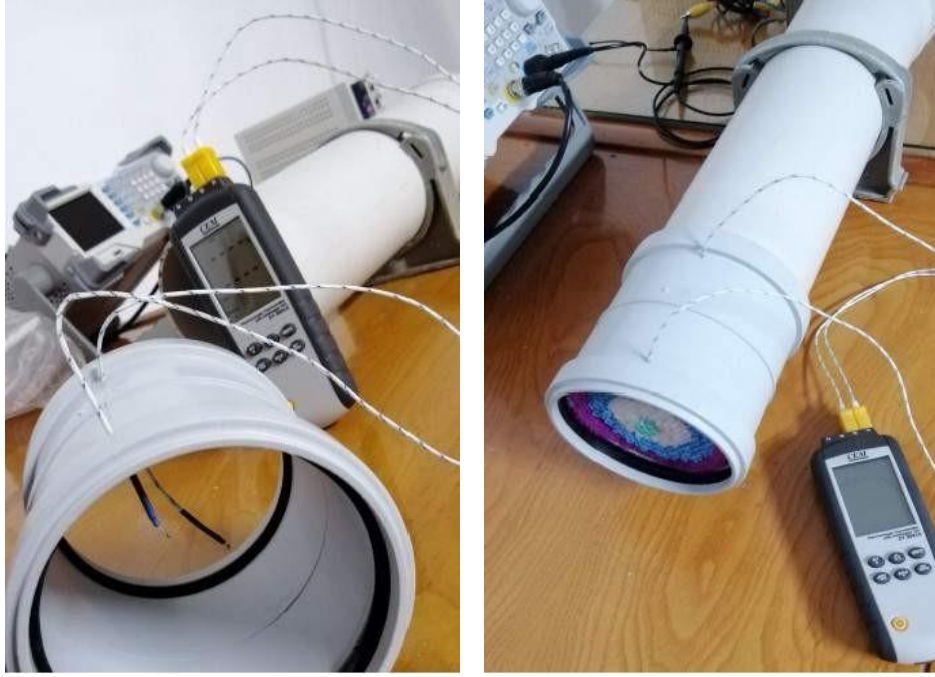
Şekil 4.33: Yığına yerleştirilen termokuplların görünümü.
