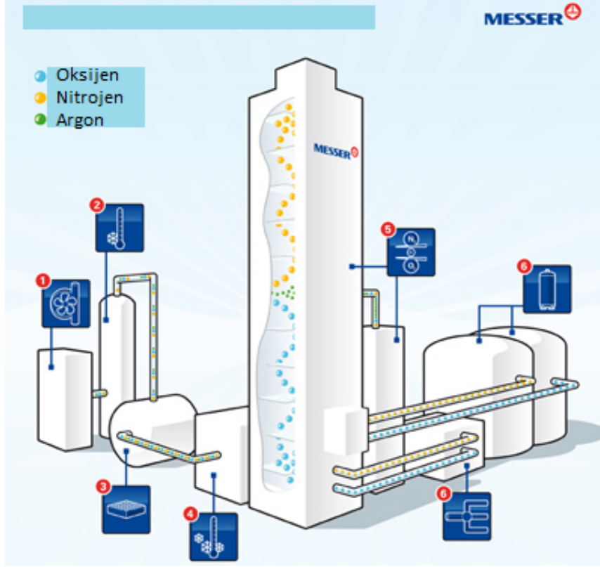
Şekil 3.6: Basit adımlarla hava ayırma tesisi.
