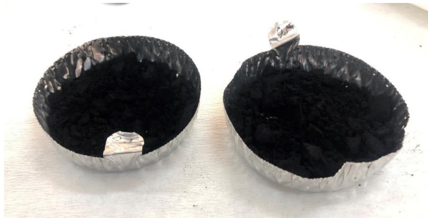
Şekil 3.4: Ac-MnO 2 modifikasyonunda kalsinasyon işleminden sonra
