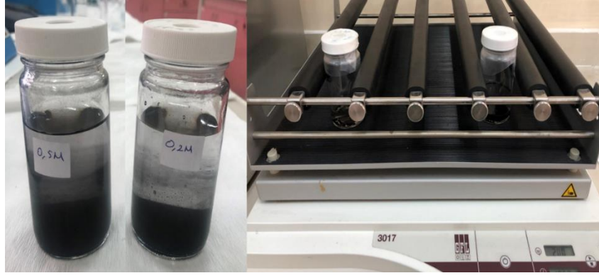
Şekil 3.2: Ac-MnO 2 modifikasyonunda karıştırma işlemi
