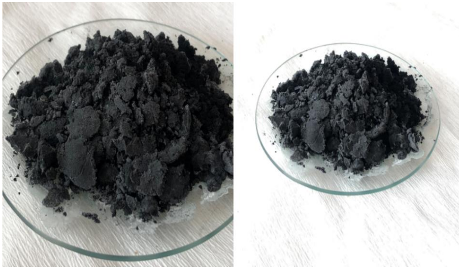
Şekil 3.1: Ac-MnO 2 modifikasyonunda süzme işlemi sonrası kurutulmuş nanokompozitler
