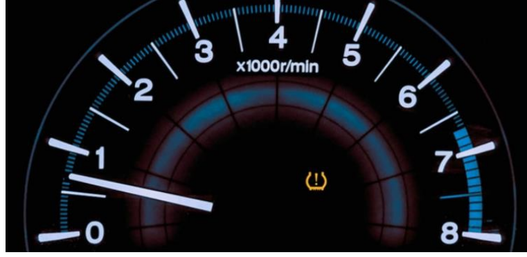
Şekil 3.3: TPM'in kadran üzerindeki sembolü (Bridgestonetire.com 2021).
