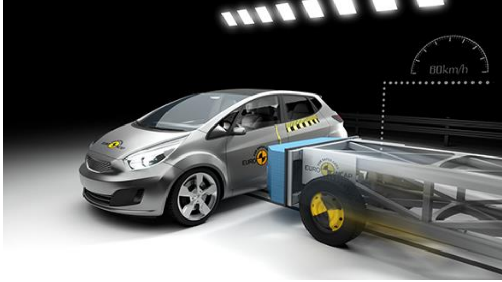
Şekil 4.16: Euro NCAP Yan Darbe Testi (19.URL)
