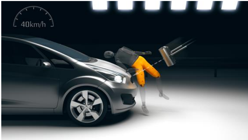
řekil 4.21: Euro NCAP Üst Bacak Darbe Testi (19.URL)
