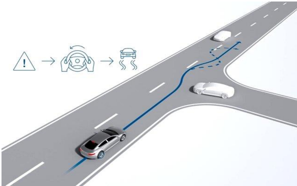
Şekil 4.7: Araçlarda Elektronik Denge Kontrol Sistemi (31.URL)
