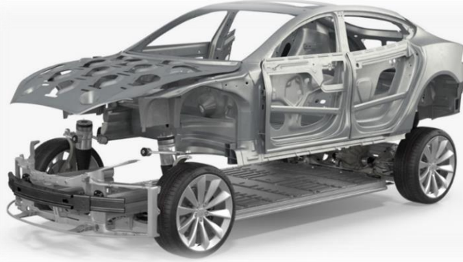
Şekil 3.15: Tabanına Pil Yerleştirilmiş Elektrikli Araç Şasisi (13.URL)
