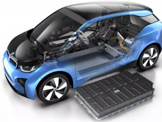
Şekil 3.16: Elektrikli Araçlarda Birimlerin Yerleşim Yapısı (26.URL)
