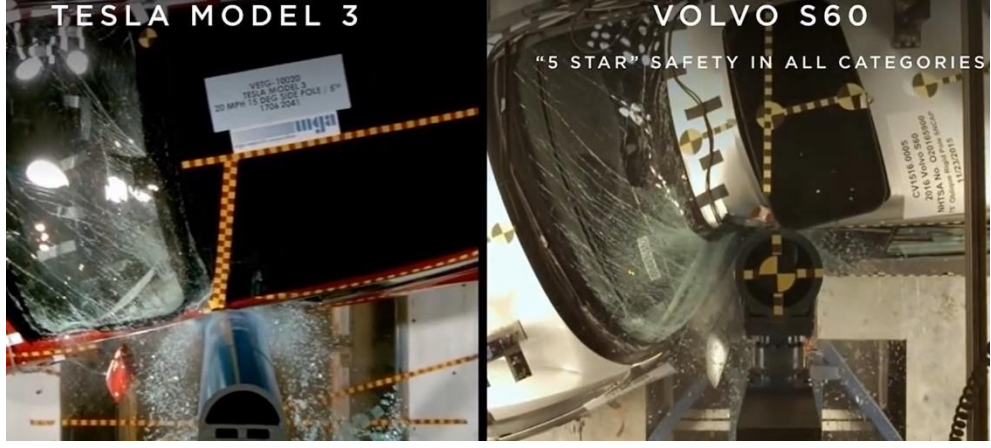
Şekil 3.17: Elektrikli Araç ile Konvansiyonel Aracın Yan Darbe Testi (34.URL)
