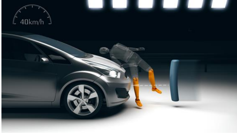
Őekil 4.22: Euro NCAP Alt Bacak Darbe Testi (19.URL)
