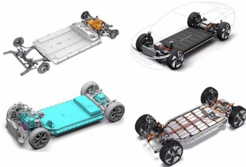
Şekil 5.8: Farklı Elektrikli Araç Markalarının Şasi Tasarımları (5.URL)
