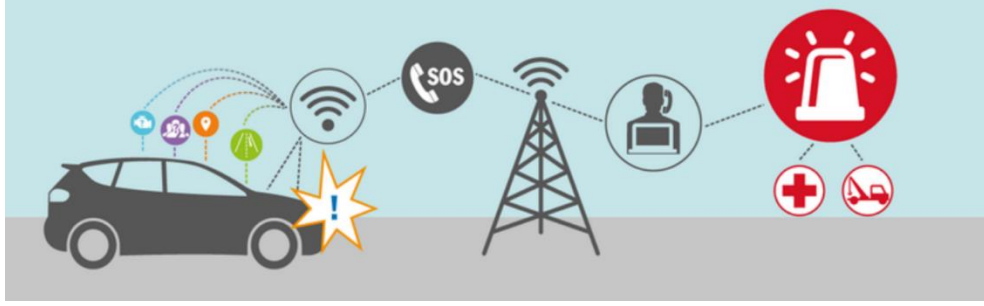
Şekil 4.6: Araçlarda Acil Müdahale Sistemi Çalışma Döngüsü (28.URL)
