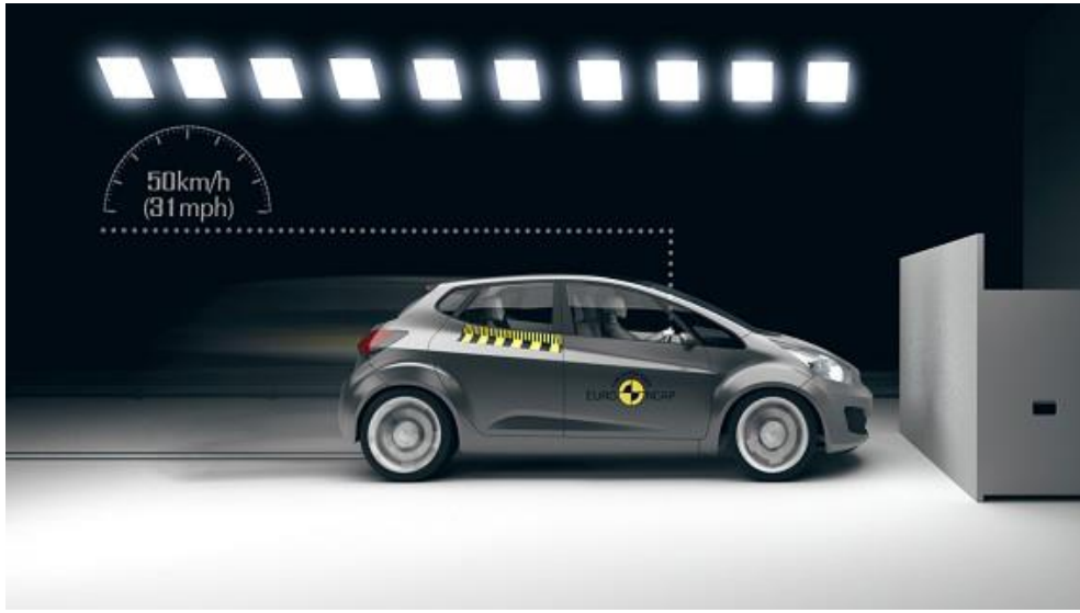
Şekil 4.15: Euro NCAP Tam Genişlik Ön Darbe Testi (19.URL)
