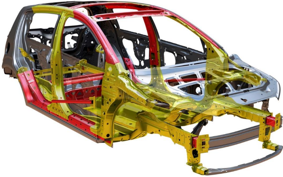
Şekil 3.5: Konumuna Göre Farklı Malzemeleri Kullanılan Araç Şasisi (22.URL)
