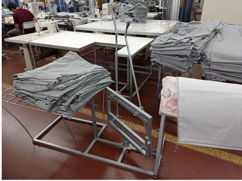
Şekil 3.13: Çevirme ve kontrol İşleminin birleştirilmesi için tasarlanan çevirme aparatı
