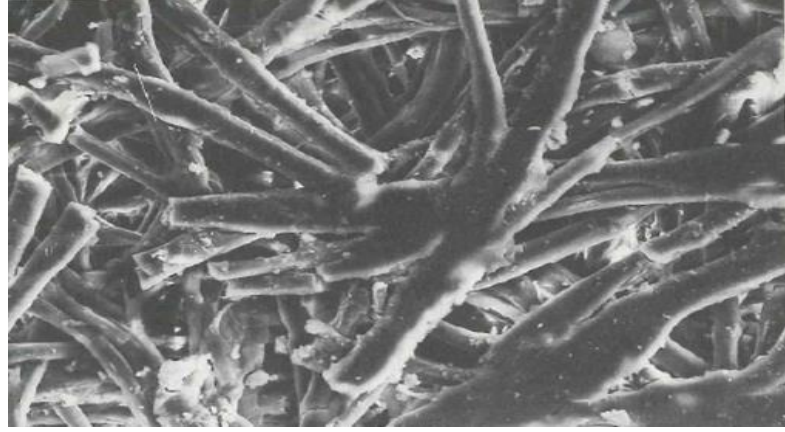
Fig. 11: Asidite Nedeniyle Bozulmuş, 14. Yüzyıl Belgesine Ait Liflerin SEM (Tarama Elektron Mikroskop) Görüntüsü 149
