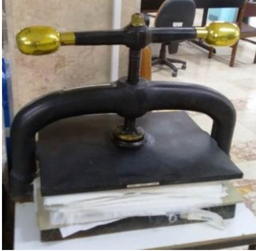
Fig. 100-101: Onarımı Yapılmış Varakların Preslenmesi (KYBM Arşivi)
