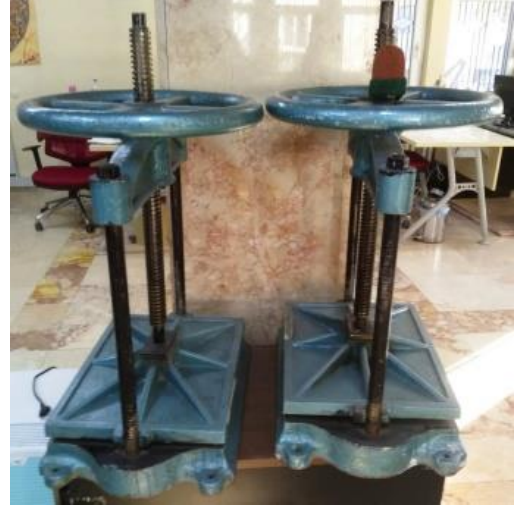
Fig. 100-101: Onarımı Yapılmış Varakların Preslenmesi (KYBM Arşivi)
