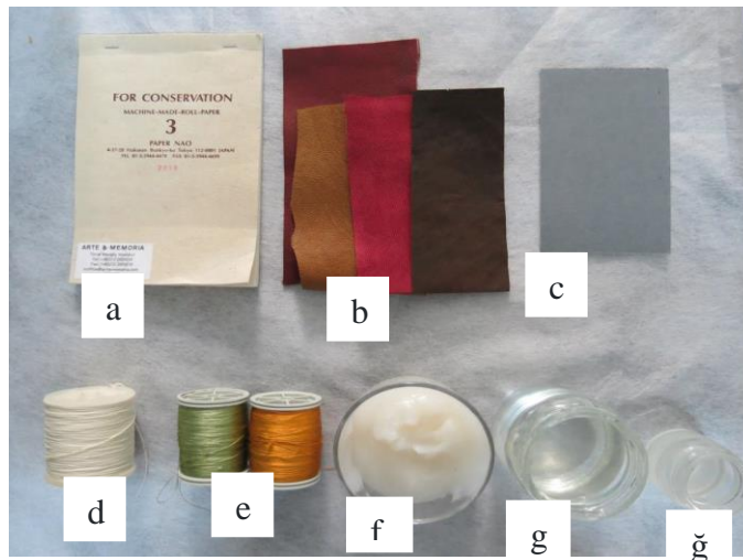
Fig. 91: Malzemeler (a-Japon Kâğıdı Kartelası, b-Deriler, c-Asitsiz Karton, d-Keten İplik, e-İbrişim İpleri, f-Nişasta, g-Klucel-G, ğ-Metil Selüloz) 309
