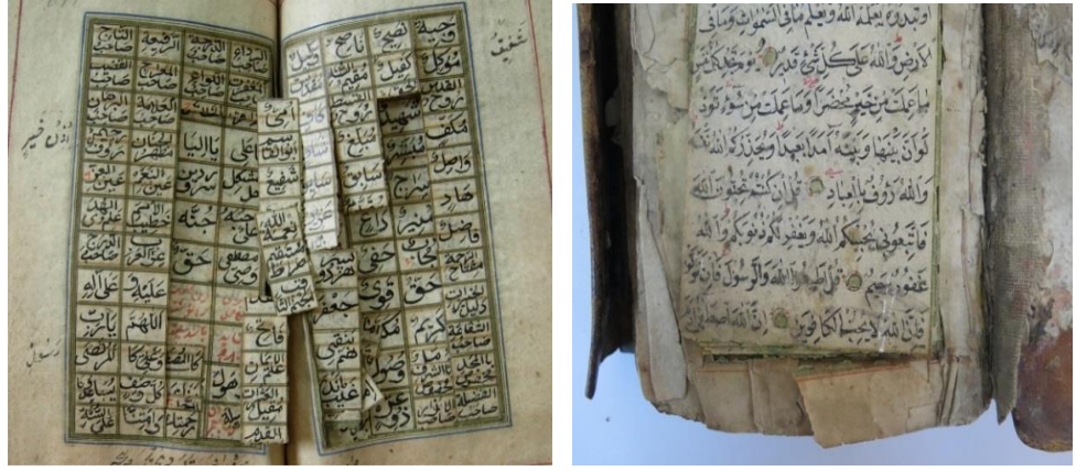
Fig. 14-15: Bakır Metali Katalizli Oksidatif Bozulma Nedeniyle Kırılğan Hale Gelmiş Bir Eserin Sayfaları 156
