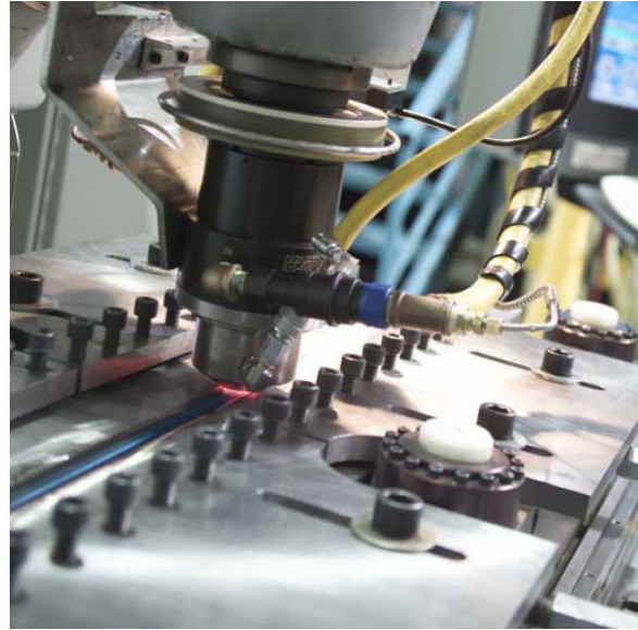
Şekil 2. Kaynak yapmakta olan su soğutmalı - gaz girişli freze başlığı - (The tool holder with water cooling and shielding gas input which used welding) [8]
