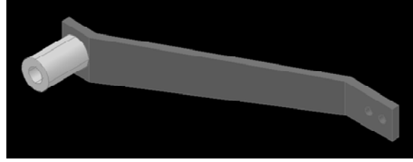
Şekil 4. Dönme hareketinden oluşan kuvveti karşılayacak tutucu (The holder against force which occurred due to turning)
