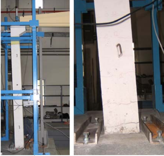
Şekil 12. İtme ve çekmede kolon eğriliği (Column curvature at pull and push)
