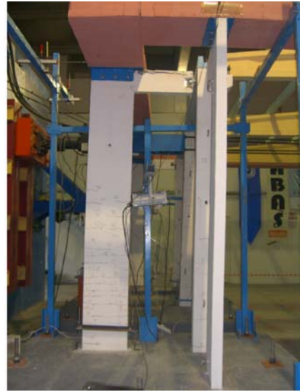
Şekil 15. %2 görelî yer değiştirmede deplasman ve çatlaklar (Displacement and cracks at 2% relative displacement)
