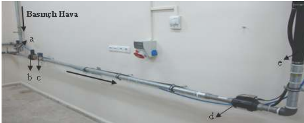
Şekil 3. a) Hava řartlandırıcı b) regülátör (1 ½”) c) selenoid valf d) DN 40 Debimetre e) hava hortumu
