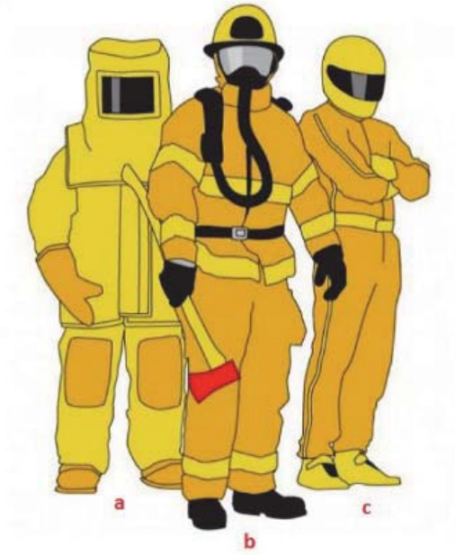
Şekil 14. PBO liflerinin koruyucu teknik tekstiller olarak kullanımı; a) Endüstriyel koruyucu giysi, b) İtfaiyeci kıyafeti, c) Yarış arabası sürücülerinin giysi, eldiven ve kaskları [97]
