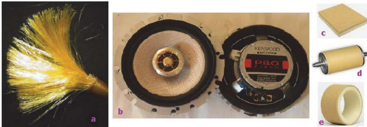
Şekil 18. PBO lifleri ile üretilen a) kablolar [27], b) hoparlörler[40], c-e) endüstride kullanılan dokusuz yüzey kaplı silindirler [142], d)[141]
