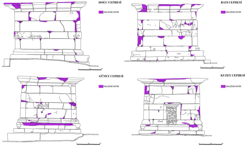
Fig. 5: Cephelerde yapılan malzeme kaybı haritaları.
