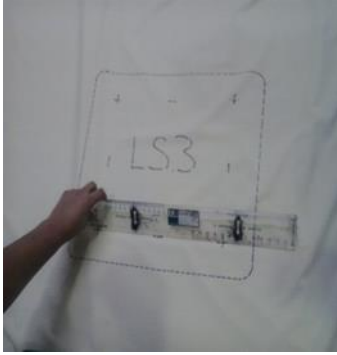
Şekil 2: Çekmezlik cetveli ( boyut değişimi ölçen cetvel) ve kumaşın işaretlenmesi.
