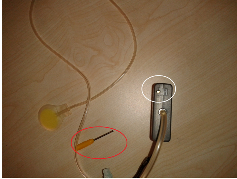
Şekil 2.15: Kikuhime basınç ölçüm cihazı, hava kesesi ve kalibrasyon aparatı
