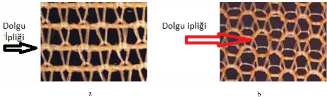
Şekil 1.9: Medikal kompresyon (bası) Çorabı üretiminde kullanılan örgü yapıları (a) Dolgu iplikli örgü yapısı (b) Askılı örgü yapısı
