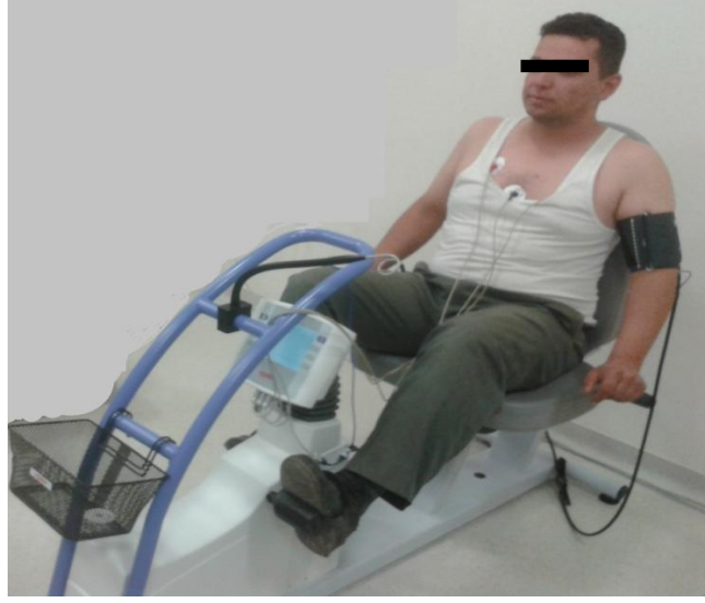
Şekil 1. Elektromanyetik pedallı koltuklu bisiklet ergometresi
