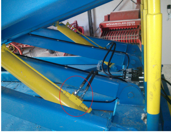
řekil 9. Hidrolik silindirler ve emniyet valfleri
