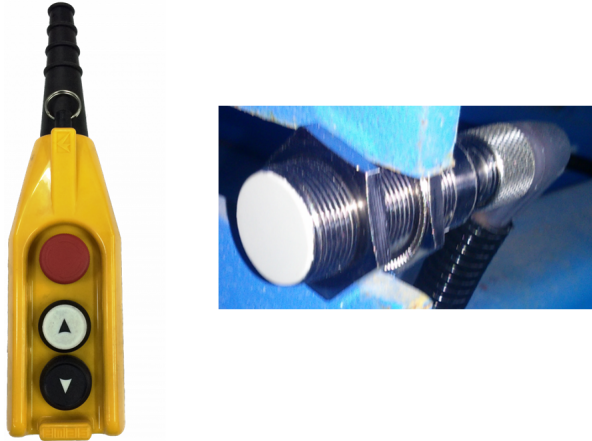
Őekil 7. Kumanda elemanı ve ykseklik sınırlayıcı olarak kullanılan endktif sensr
