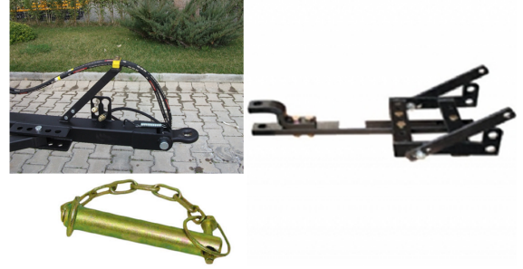
Şekil 4. Meyve hasat platformu çeki kancası, traktör çeki demiri ve bağlantı pimi
