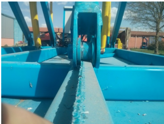
řekil 10. Makas kollarının yukarı ařađı hareketini sađlayan makara ve ray
