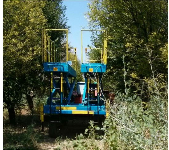
Şekil 5. Meyve hasat platformunun bir ağaçtan diđerine taşınması
