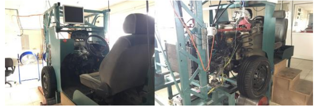
Şekil 1. Fren süspansiyon test cihazı
