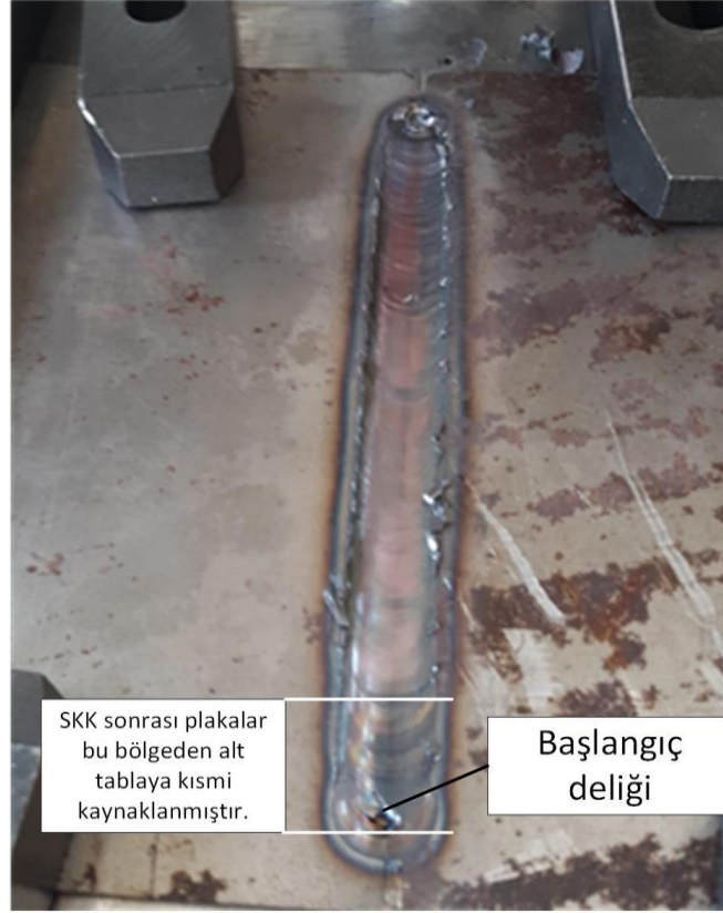
Şekil 5.35: Başlangıç deliği açılarak SKK uygulanan plaka görüntüsü
