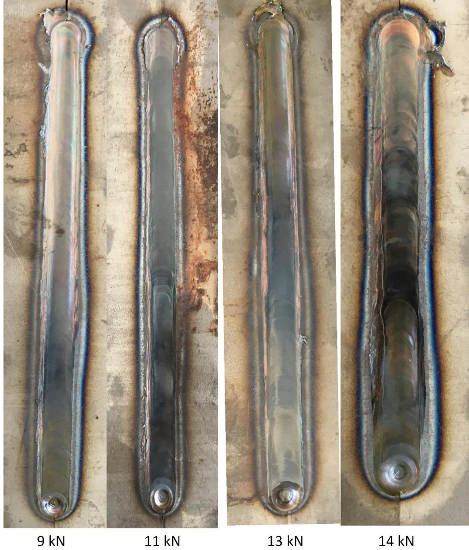
Şekil 5.51: Dört farklı baskı yükü kullanılarak gerçekleştirilen SKK'lı plakaların görüntüleri (takım devir sayısı 750 min -1 ve ilerleme hızı 95 mm/min sabit)
