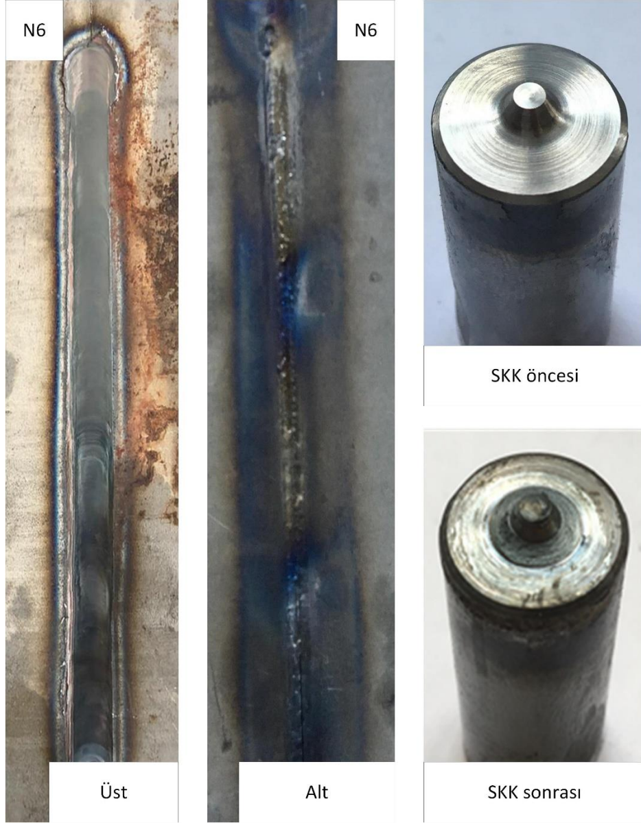
Şekil 5.52: SKK işlemi gerçekleştirilmiş Numune 6'nın üst ve alt görüntüleri ve kullanılan karıştırıcı takımın SKK öncesi ve sonrası görüntüleri
