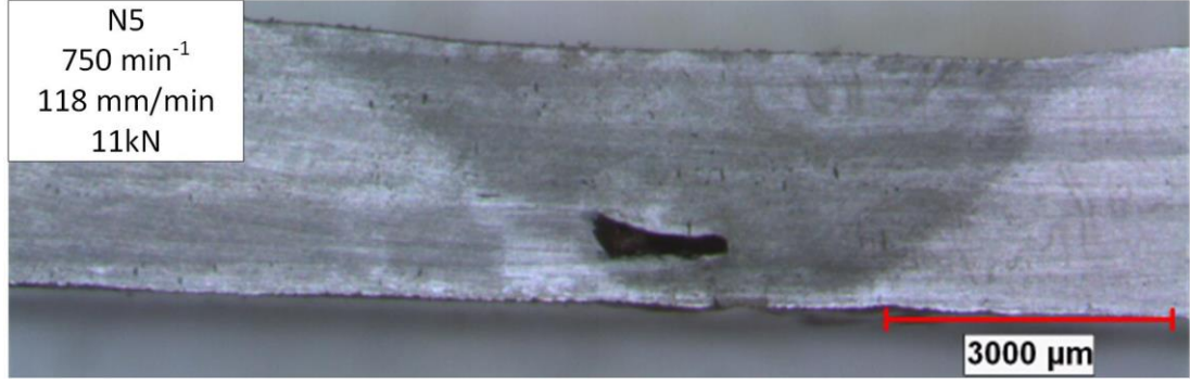
Şekil 5.47: SKK sonrasında kaynak kusuru oluşmuş Numune 5'in makro görüntüsü
