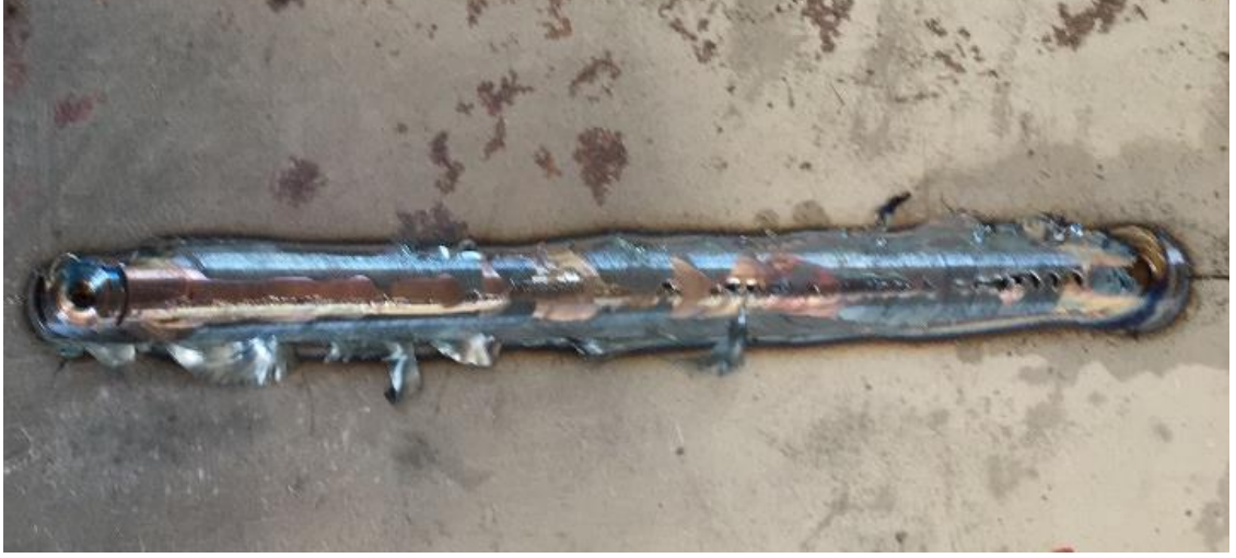
Şekil 5.38: SKK işlemi sırasında baskı yükünün 7 kN olarak uygulandığı kaynak işlemine ait plaka görüntüsü
