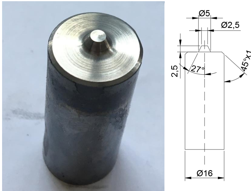
Şekil 4.7: SKK sırasında kullanılan karıştırıcı takım (a) resmi ve (b) geometrik ölçüleri (Tüm ölçüler mm cinsindedir.)
