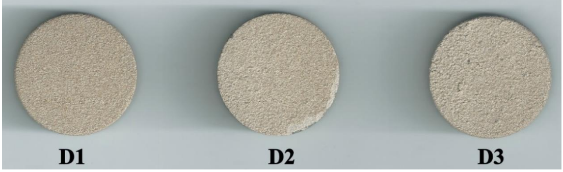
Şekil 5.29: 1. Ti kaplama grubu numunelerinin (D1, D2 ve D3) makro görüntüleri
