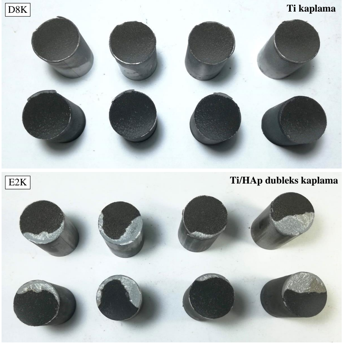
Şekil 5.61: En yüksek mukavemet gösteren numunelerin kesme testi sonrası kırık yüzeyleri (D8K, E2K).
