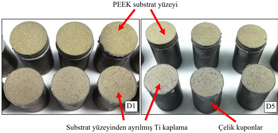
Şekil 5.44: 3. Ti kaplama grubu numunelerinin ayrılma yüzeyi görüntüleri (D1 ve D5).
