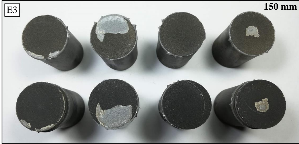
Şekil 5.55: 1. HAp kaplama deney grubundan E3 kodlu numunelerin çekme testleri sonrası kırık yüzeyleri.
