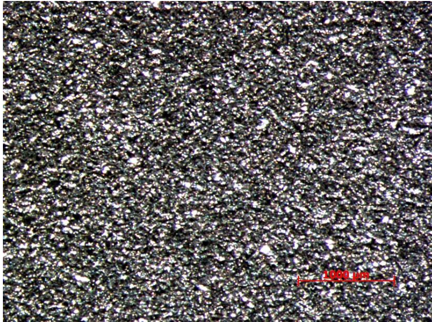
Şekil 5.9: Kaba kumlama yapılan çelik karşılıklar.
