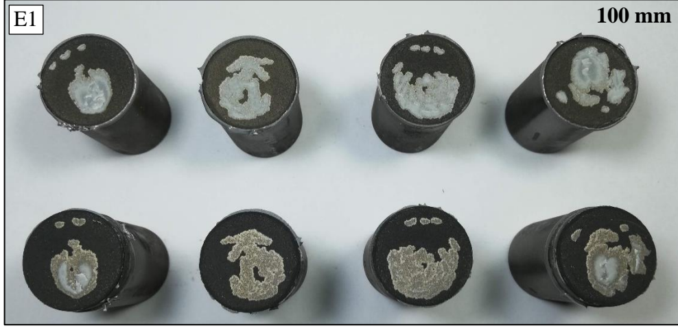
Şekil 5.53: 1. HAp kaplama deney grubundan E1 kodlu numunelerin çekme testleri sonrası kırık yüzeyleri.
