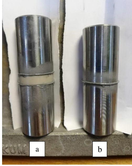
Şekil 4.24: Yapıştırıcı uygulanmış (a) çelik-PEEK-çelik, (b) çelik-çelik çekme numunesi.
