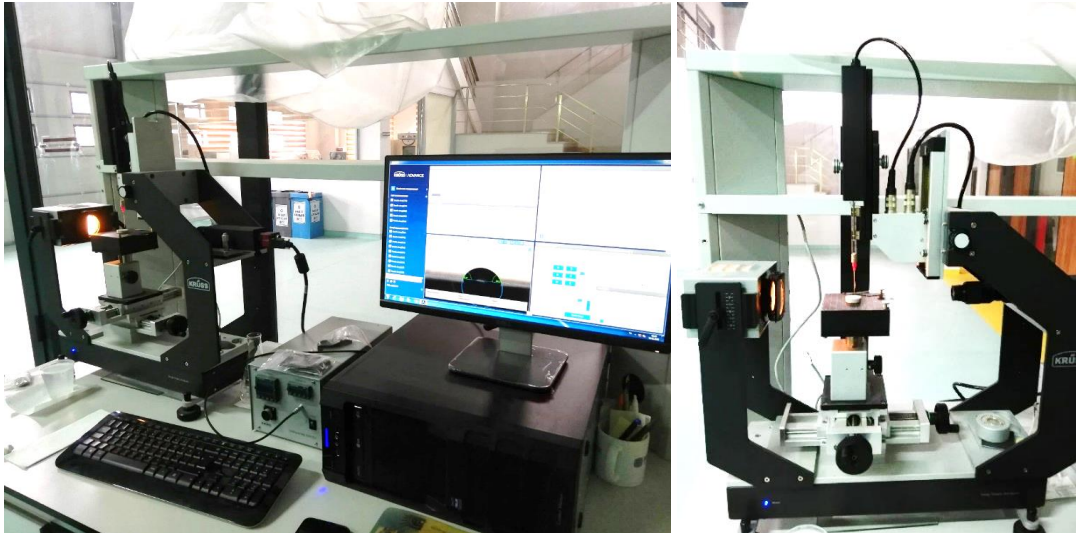
Şekil 4.11: Krüss DSA30S damla şekli analiz sistemi.
