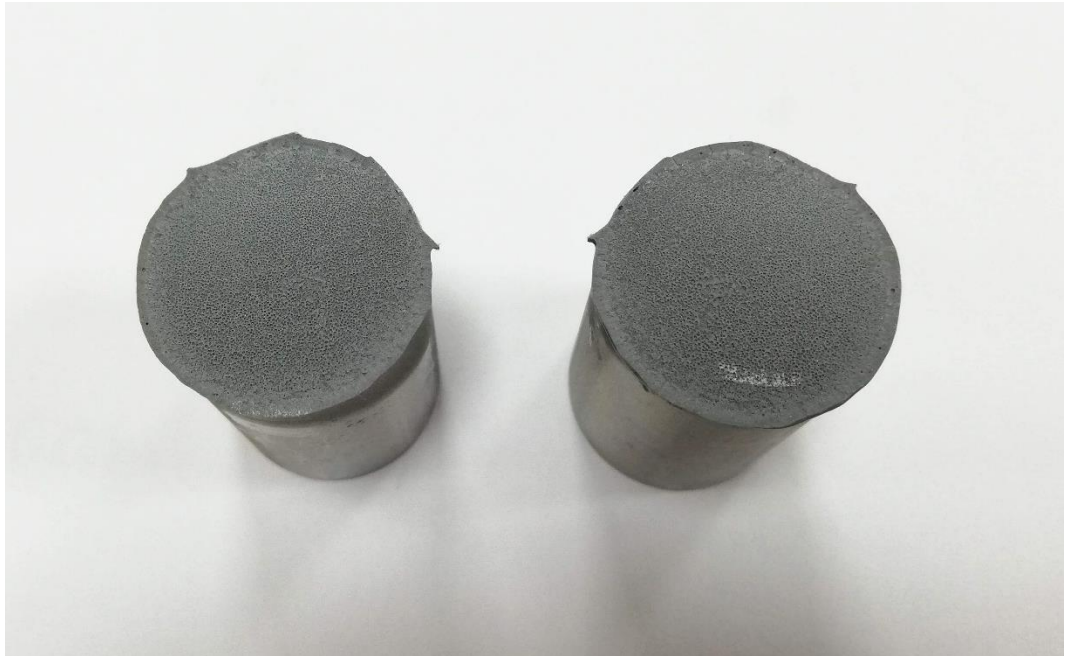
Şekil 5.11: Çelik-çelik numunelerin ayrılma yüzeyi.
