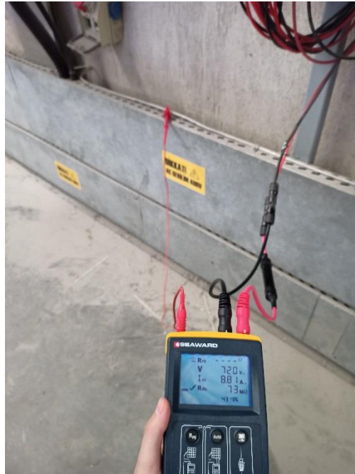
Şekil 5.10: Örnek bir FV diziyeye ait ölçüm için kurulan sistem
