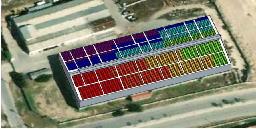
Şekil 4.28: Sistemdeki FV modüllerin bağlı oldukları eviricilere göre renklendirilerek sınıflandırılması
