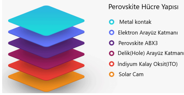
Şekil 2.15: Perovskite hücre yapısı
