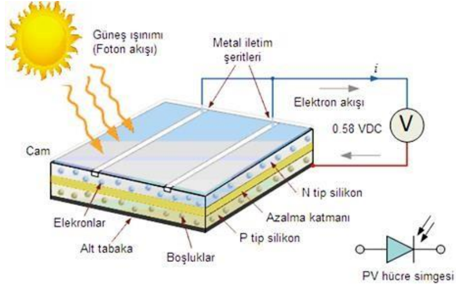
Şekil 2.2: PV hücrenin çalışma ilkesi (Öztürk 2013)
