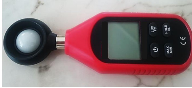
Şekil 4.16: Işık yoğunluğunu fotoelektrik ile algılayan lüksmetre (Işık ölçer)
