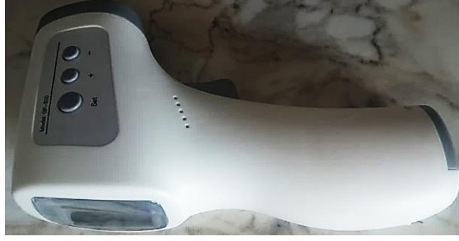
Şekil 4.17: PV ve TEM için kullanılan sıcaklık ölçüm cihazı
