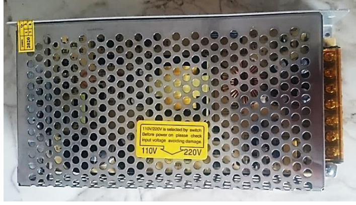
Şekil 4.19: Kullanıma hazır 12V 10A güç kaynağı
