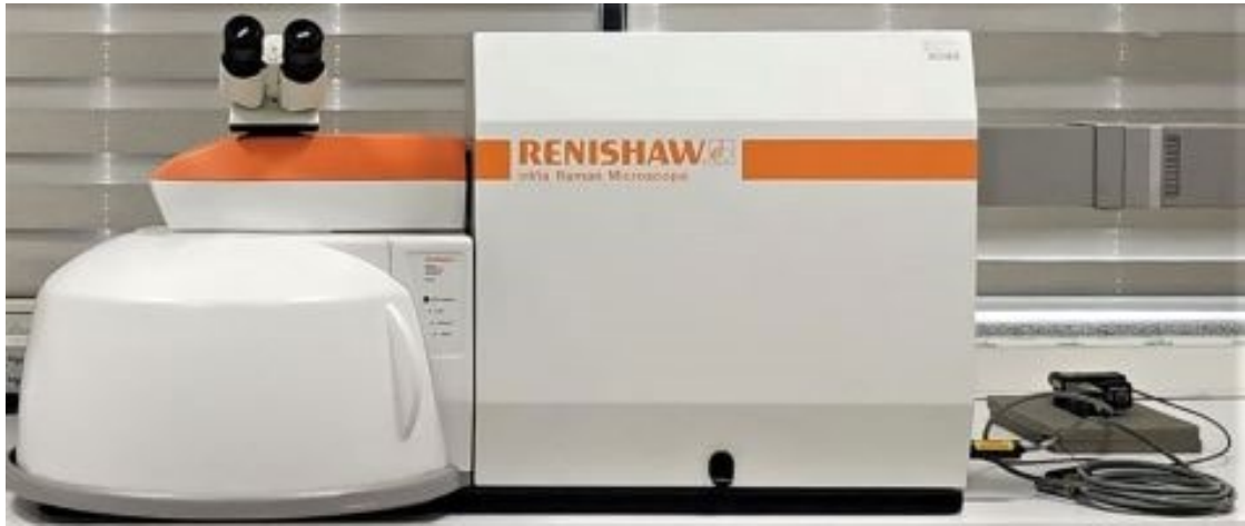
Şekil 3. Raman Spektroskopisi deneyi için kullanılan konfokal spektroskopi cihazı (Renishaw inVia™ confocal Raman Microscope, Wotton-under-Edge, Birleşik Krallık).
