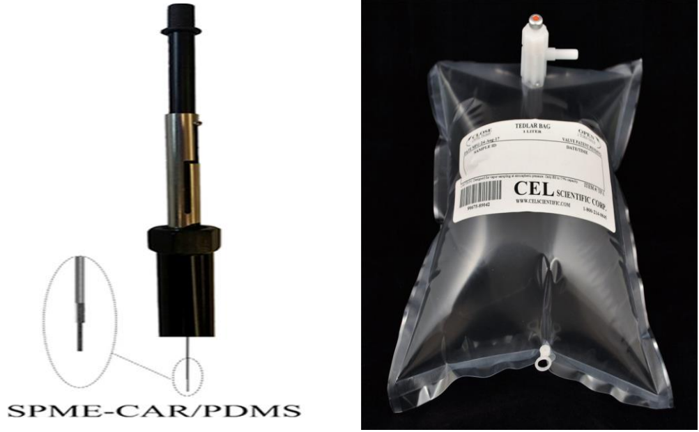
Şekil 3.2: SPME fiberi ve Tedlar torbası
