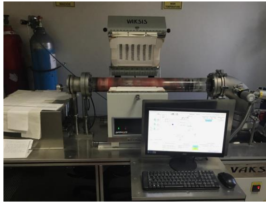
Şekil 5. 20. Vaksis marka CVD sistemi.
