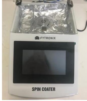
Şekil 5. 22. Grafen transferi için kullanılan Spin Coating Sistemi.
