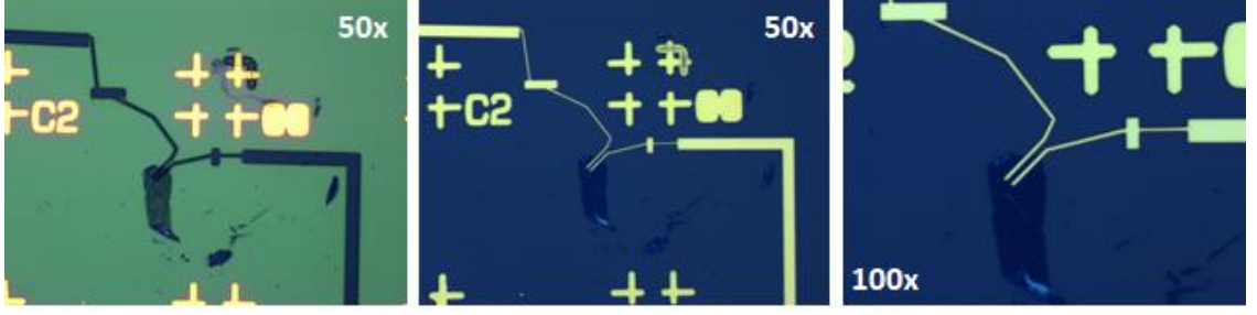
Şekil 4.22: Development işlemi sonrası 50x büyütme oranında ve lift-off işlemi sonrasında çekilmiş 50x ve 100x büyütme oranlarında alınmış mikroskop görüntüleri.
