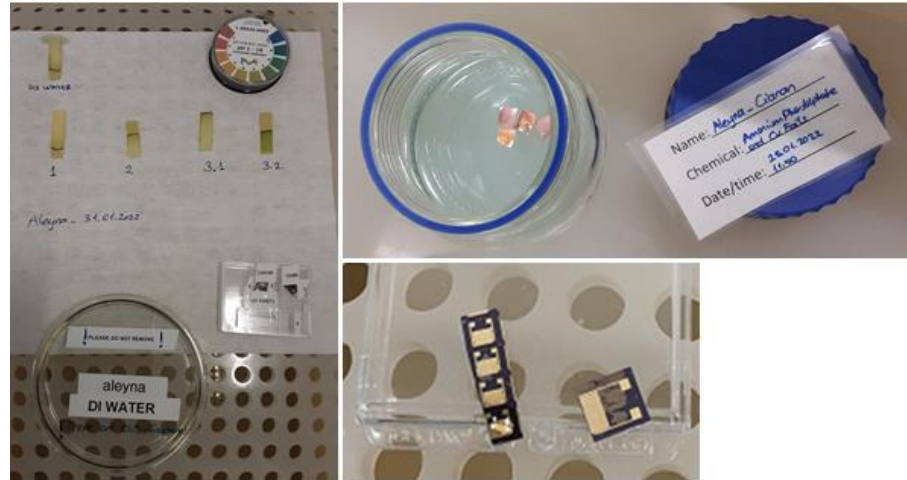
Şekil 4.15: APS Solüsyonu ile grafen transferi aşamalarına ait görüntüler.
