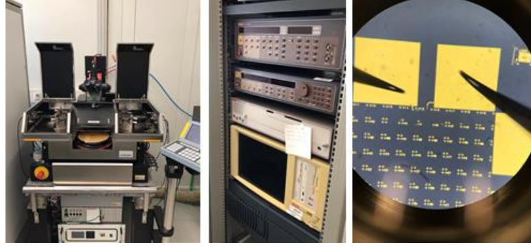
Şekil 5.8: SUSS markasına ait probe station sistemi ve bu sistem ile yapılan elektriksel ölçümlere ait görseller.
