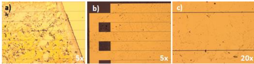
Şekil 4.16: CVD Grafen/PMMA yapısının 3 µm genişliğe sahip elektrot yüzeyine a) transfer işleminin ardından alınan optik mikroskop görüntüsü b-c) PMMA yapısının yüzey üzerinden temizlenmesinin ardından alınan optik mikroskop görüntüsü.
