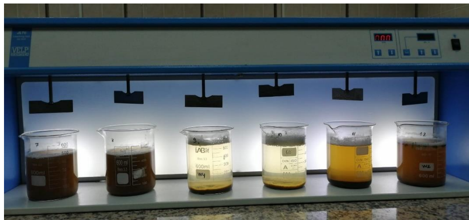
Şekil 6.4: PMS oksidasyonu sırasında jar testi düzeneği.
