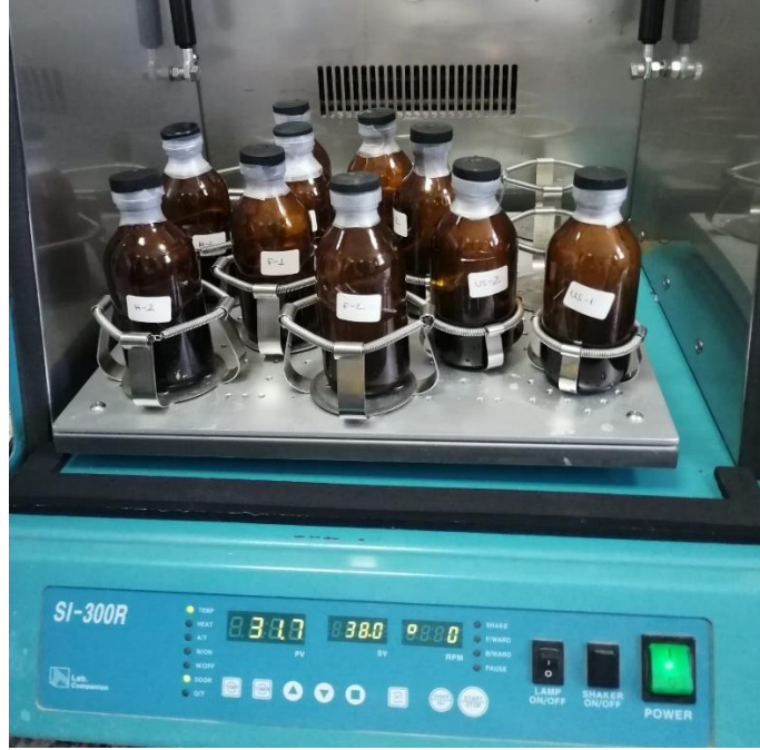
Şekil 6.6: BMP testi deney düzeneği.
