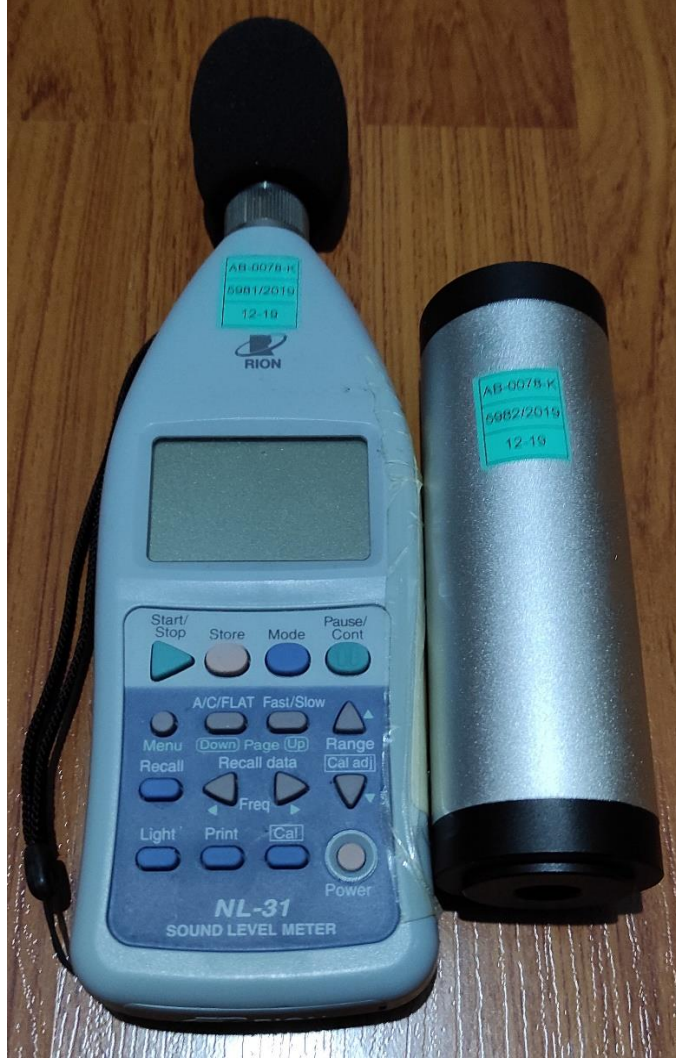
Şekil 6. 3: Gürültü ölçümünde kullanılan cihaz ve kalibratörü.
