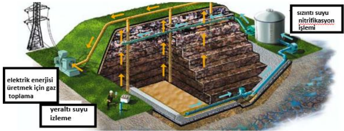
Şekil 2.6: Fakültatif biyoreaktör tasarımı
