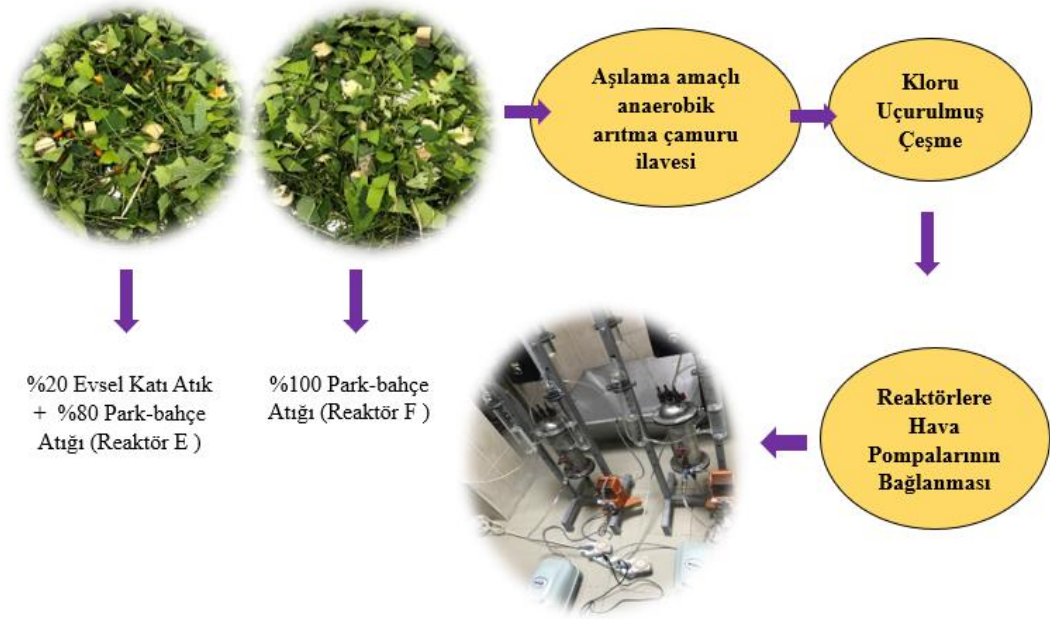
Şekil 3.7: Park-bahçe atıklarının semi-aerobik / anaerobik biyoreaktörlere yüklmesi
