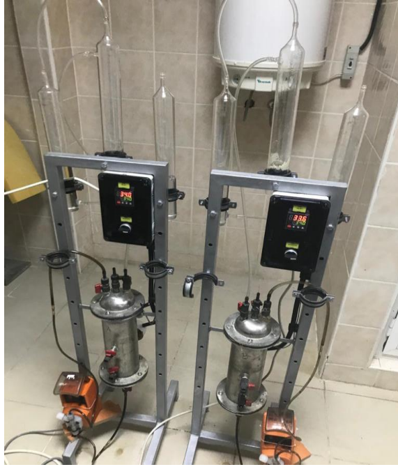
Şekil 3.2: Anaerobik biyoreaktörün çalışma sistemi
