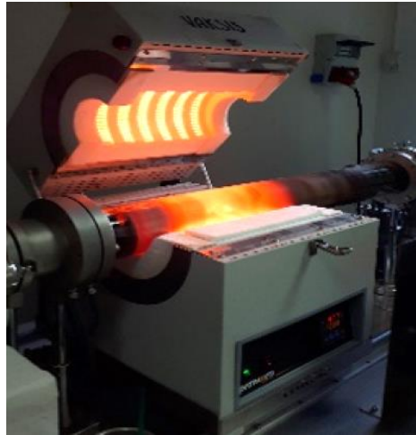
Şekil 3.21: Grafen üretiminde kullanılan CVD cihazı.
