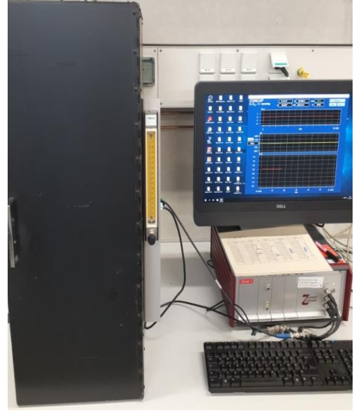
Şekil 3.27: EIS sensörlerinin elektrokimyasal karakterizasyonu için kullanılan empedans analizörü.
