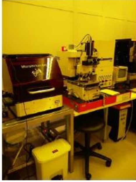
Şekil 3.20: UV litografi işlemi için kullanılan direk lazer yazıcı cihazı.
