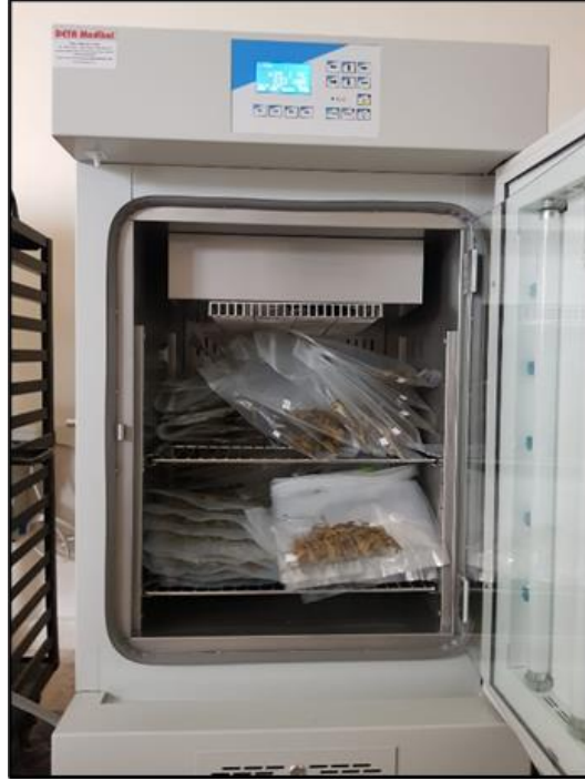
Şekil 5.13: Paketlenmiş ökse otu yapraklarının test kabine yerleştirilmiş hali
