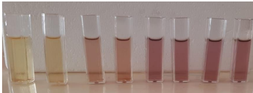
Şekil 5.19: Ekstraksiyon üzerine DPPH eklenerek karanlıkta bekletilen örnekler
