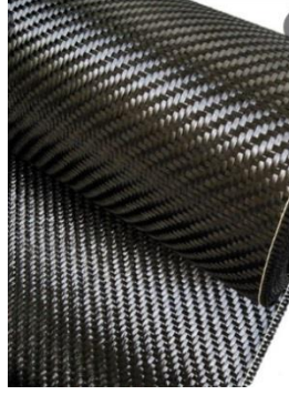
Şekil 3.9: 200 g/m 2 dimi dokuma kumaş yapısı
