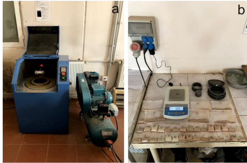
Şekil 1.5: a) Halkalı değirmen öğütücü makinesi ve kompresör, b) Öğütülmüş örnekler, hassas terazi ve halkalı değirmen.
