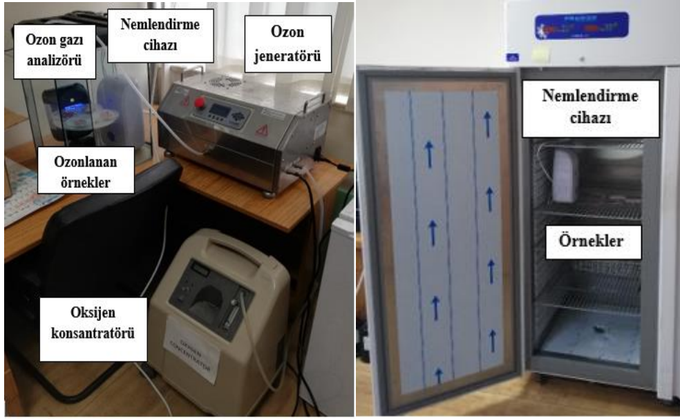
Şekil 2.2: DDUS ozon gazı uygulamasının yapıldığı hazne ve kontrol grubu ortamı.
