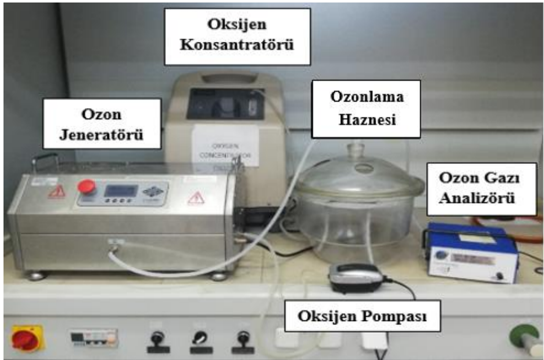
Şekil 2.1: YDKS ozon gazı uygulamasının yapıldığı ozonlama sistemi.
