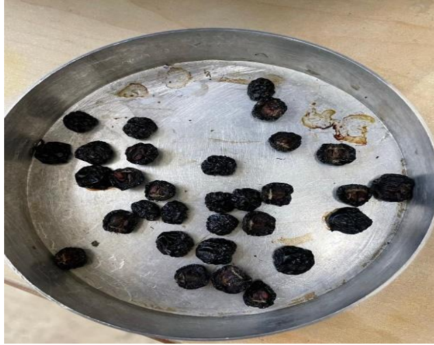
Şekil B.8: 105°C sıcaklıkta nem tayini için sabit tartıma düşünceye kadar bekletilen aronya meyvesi örnekleri
