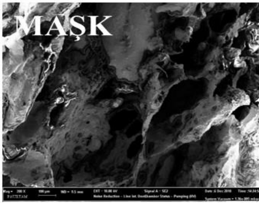
Şekil 3.3: Krakerlerin İç Yüzeylerinin Taramalı Elektron Mikroskobu Görüntüsü (200x)
