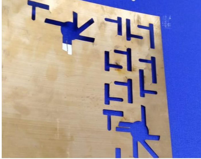
Şekil 4.26: İstenilen formların lazer kesim prosesiyle sac levhadan ayrılması.
