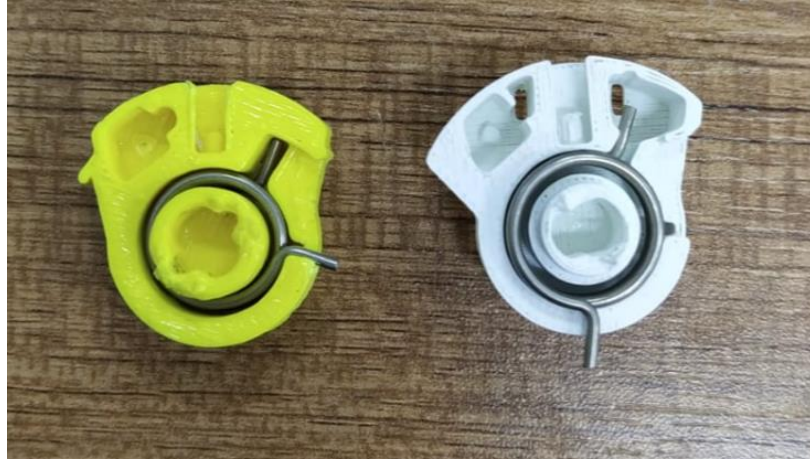
Şekil 4.32: Pozisyon kontrol plastiği ve kurma yayı. (Solda kurulmuş, sağda kurulmamış.)
