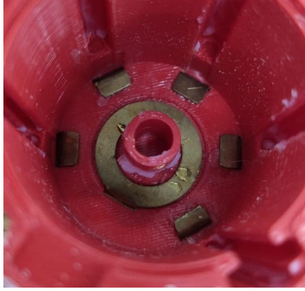
Şekil 4.34: Alt gövde ve devre sacları – prototip üretim görüntüsü.
