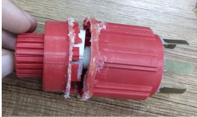
Şekil 4.37: Alt ve üst gövdenin kapatılması işlemi.
