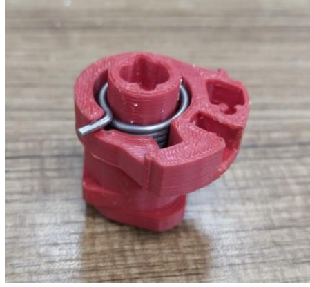
Şekil 4.40: Kam parçası ve kurma yayı montaj görseli.
