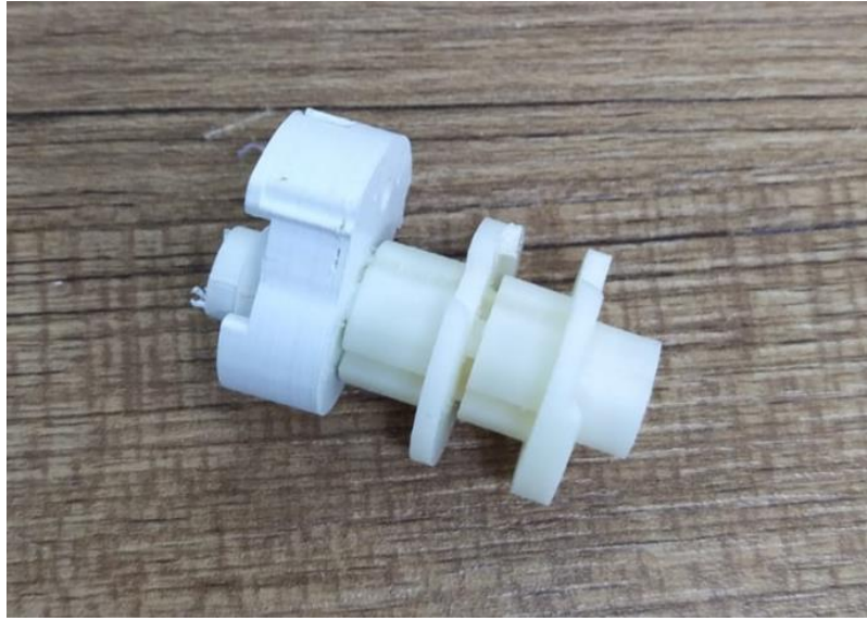
Şekil 4.31: Kam parçaları, montajlı hali.
