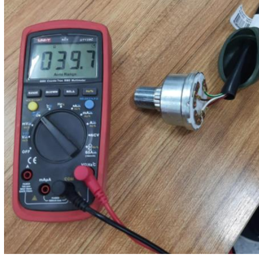
Şekil 1.9: NS 105 59 ürünü, son kademe iç direnç ölçümü.
