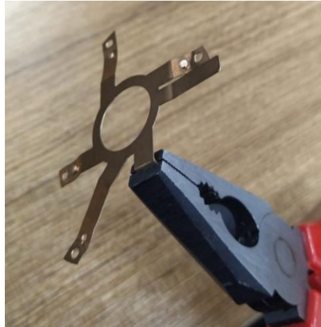
Şekil 4.28: İstenilen formun pense ile verilmesi.
