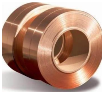
Şekil 3.13: Berilyum-bakır alaşımlı şerit metal.
