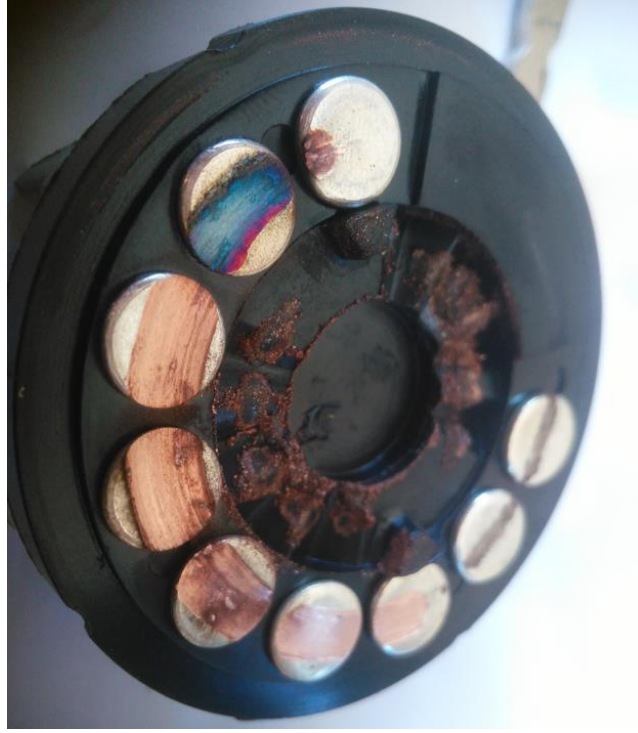
Şekil 1.15: Perçinlerde oluşan yanık izleri.
