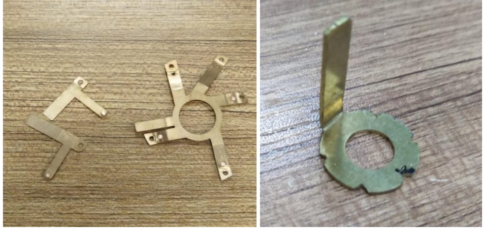
Şekil 4.25: Lazer kesim ile üretilen sac parçalar.
