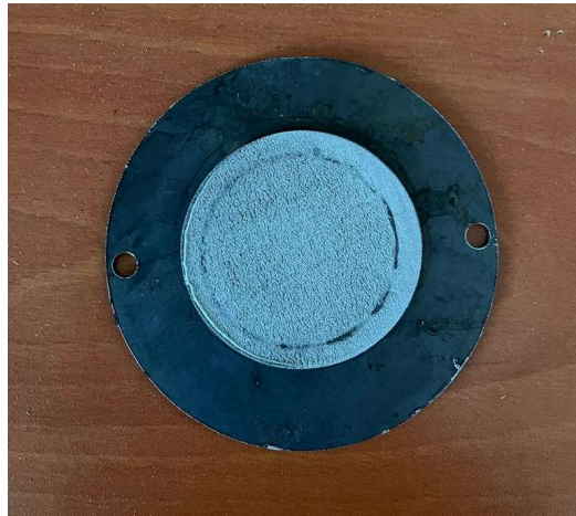
Şekil 3.8: Epoksi 3 ile kaplanmış disk numunesinin aşınma görüntüsü
