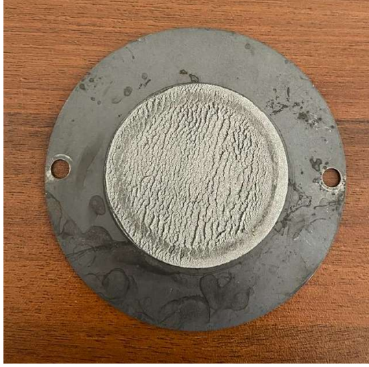
Şekil 3.9: Epoksi 4 ile kaplanmış disk numunesinin aşınma görüntüsü
