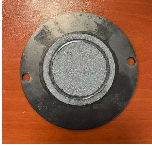
Şekil 3.6: Epoksi 1 ile kaplanmış disk numunesinin aşınma görüntüsü
