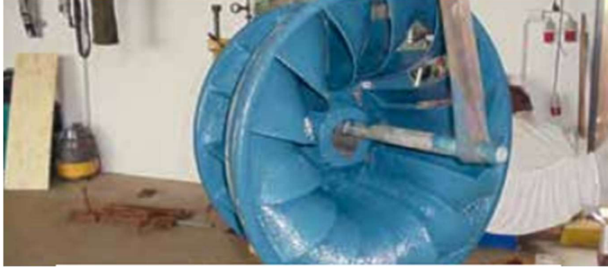
Şekil 2.5: Kavitasyon hasarlı çelik türbinin onarılması (Url-2)
