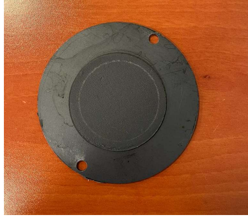
Şekil 3.7: Epoksi 2 ile kaplanmış disk numunesinin aşınma görüntüsü
