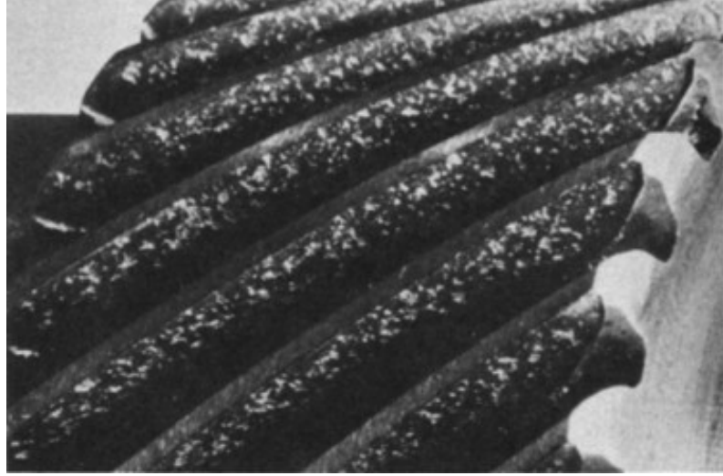
Şekil 2.12: Korozif aşınmaya uğramış dişli (Url-9)
