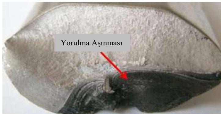
Şekil 2.11: Yorulma aşınması (Url-8)
