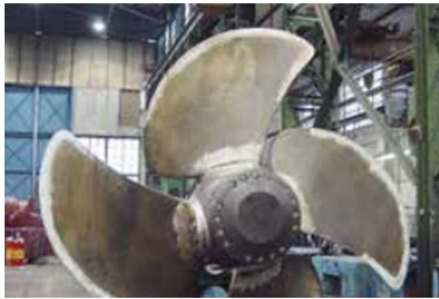
Şekil 2.7: Gemi pervanesinin epoksi kaplama ile tamirâtı (Url-4)
