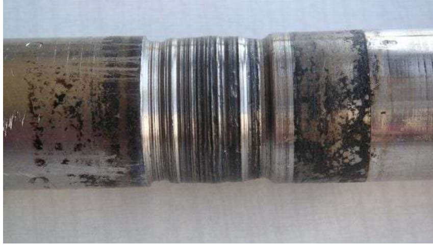
Şekil 2.9: Adhesiv aşınmaya maruz kalmış mil (Url-6)
