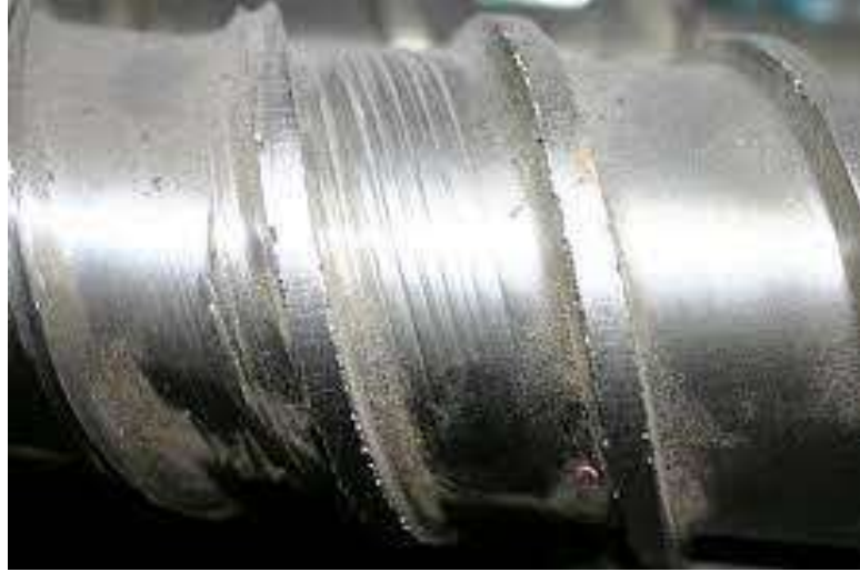
Şekil 2.10: Abrasiv aşınmaya maruz kalmış makine elemanı (Url-7)
