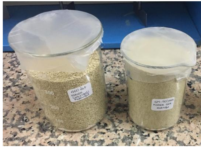
Şekil 3.7 : Elekten geçirilmiş 125-500 µm ve >500 µm KÇK adsorbentleri.
