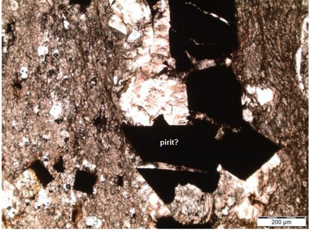
Şekil 5.5: Opak mineralce zengin örneklerin optik mikroskop görünümü (Örnek No: UK-20)
