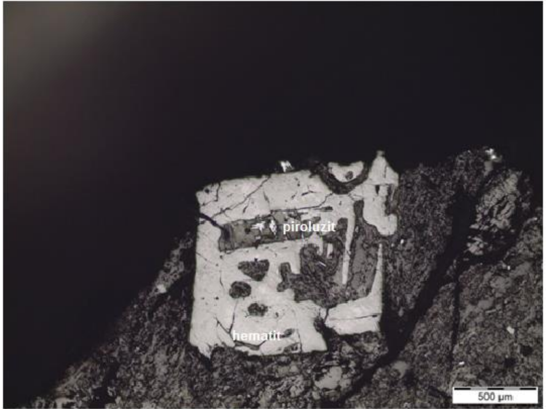
Şekil 5.7: Gang minerali kalsit tarafından ornatılan hematit ve piroluzit mineralleri (Örnek No: UK-2)
