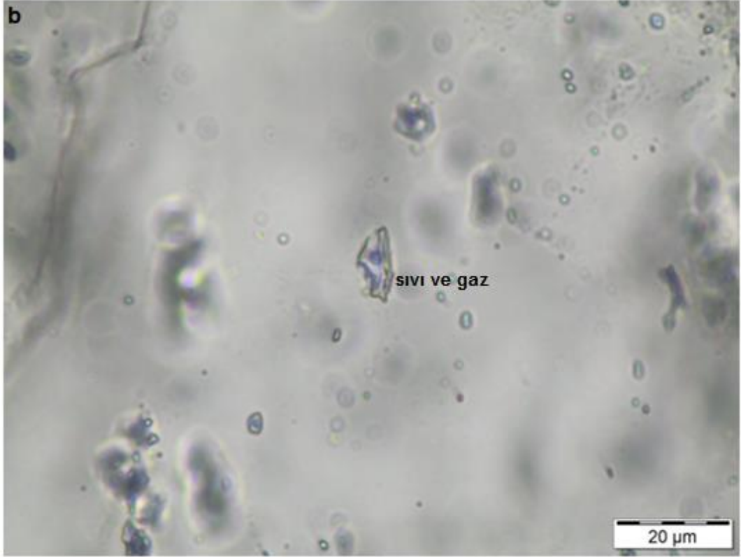
Şekil 6.2: Ulukent Mangan yatağındaki kuvars ve kalsit kristalleri içerisinde gözlenen kapanımlar a) Kalsit içindeki sıvı kapanımlar (UK-24) b) Kuvars içindeki sıvı kapanım (UK15)
