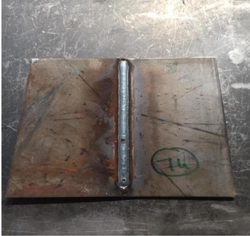
řekil 6.9 DD11 ve DD13 levhaların kaynaklı birleřimi
