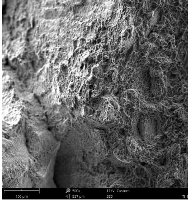
Şekil 4.23: Kaynaksız numunelerin kırılma yüzeylerinin elektron mikroskobu görüntüleri (1000x yakınlaştırma).
