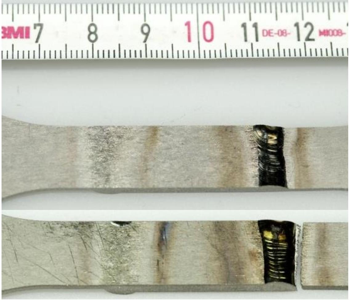
Şekil 4.19: Bindirme kaynaklı numunenin yorulma deneyleri sonrası kırılma konumu.
