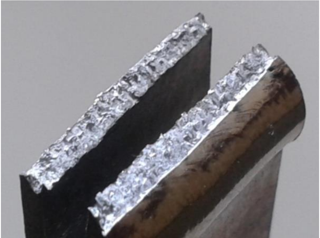
Şekil 4.12: Çekme deneyi sonucunda a) kopmuş bindirme kaynaklı numune ve b) numunenin kırılma yüzeyi.
