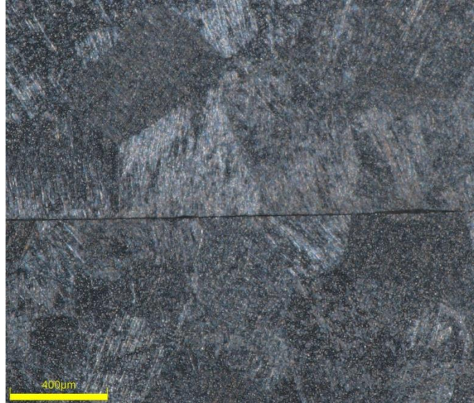
Şekil 4.36: a) Kaynaksız, b) alın kaynaklı ve c) bindirme kaynaklı deney numunelerinin 145x yakınlaştırmada mikro-yapıları.
