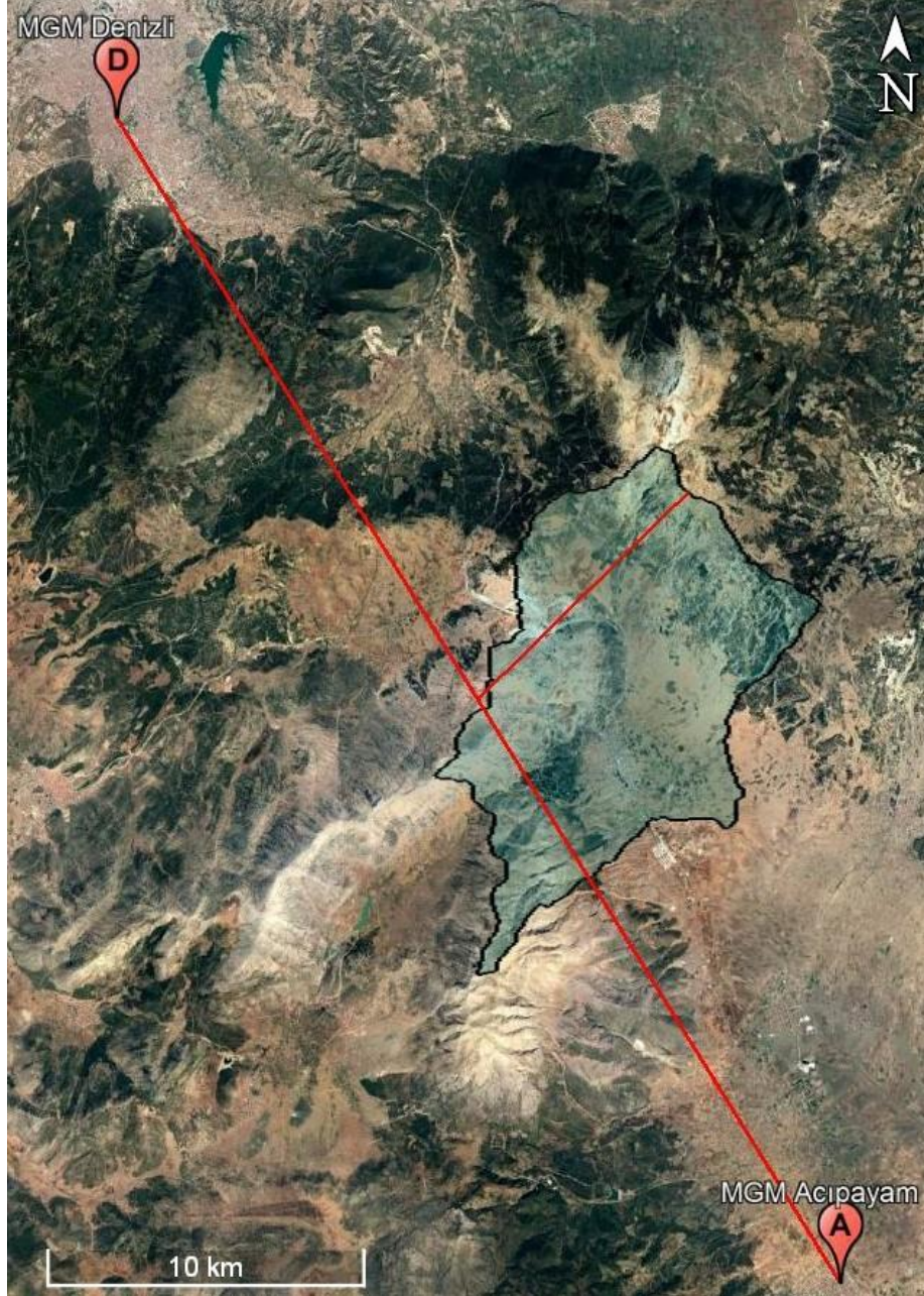
Şekil 3.10: Havza Alanı için Thiessen Yöntemi
