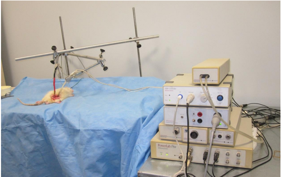
Resim-12: AD Instruments marka PowerLab/8SP model veri kayıt cihazı ile sinir hızlarına bakılması
