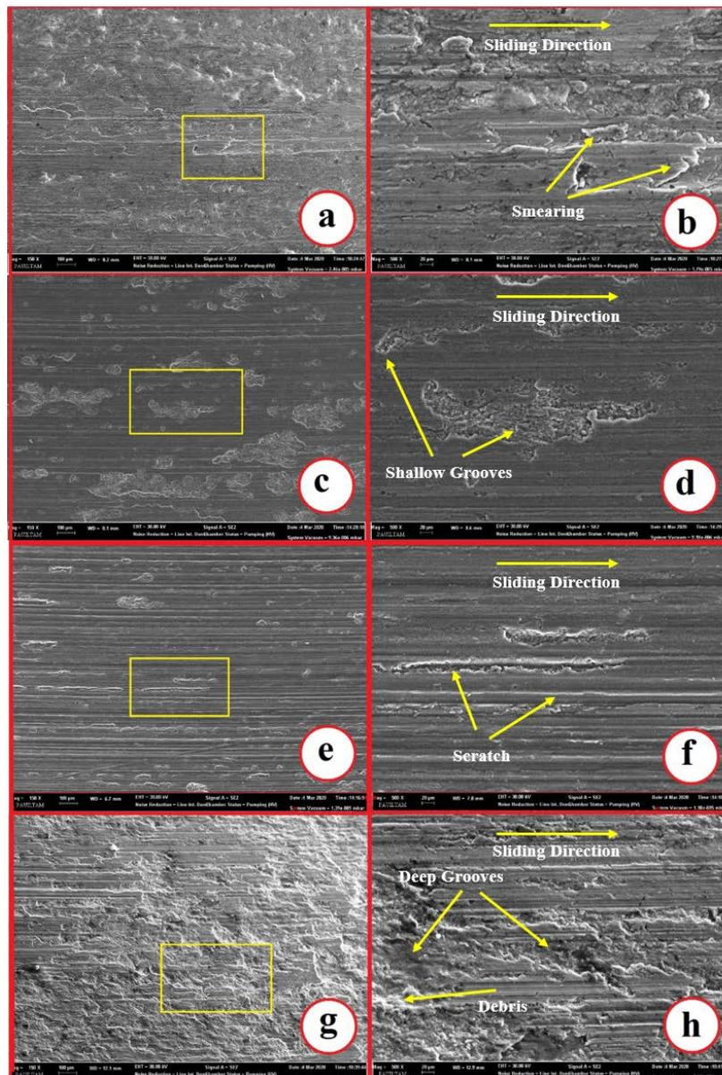
**Fig. 7.** Field emission SEM images of worn surfaces of Al 7075 reinforced with: (a)-(b) 2 % SiC + 2 %  $B_4C$ , (c)-(d) 2 %  $B_4C$  + 2 %  $TiB_2$ , (e)-(f) 3 % SiC + 3 %  $B_4C$ , (g)-(h) 3 % SiC + 3 %  $TiB_2$ .
