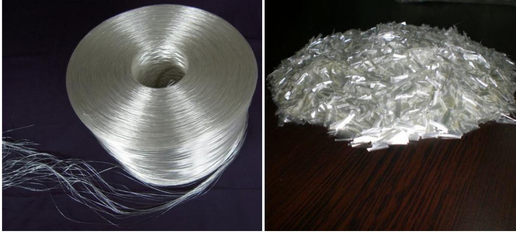
Şekil 4.8: Cam lif çeşitleri (a) Tek lif halindeki makaralar, (b) Kırılmış elyaf
