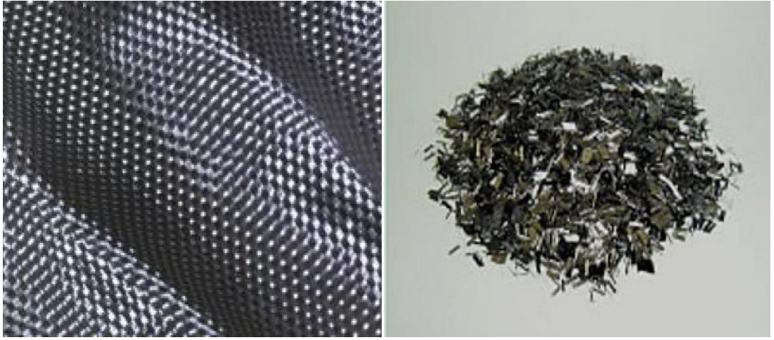
Şekil 4.9: Karbon elyaf çeşitleri (a) Karbon liflerden üretilmiş fitil, (b) Kırılmış karbon elyaf
