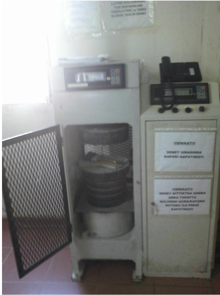
Şekil 4.3: Beton basınç deneyi düzeneği
