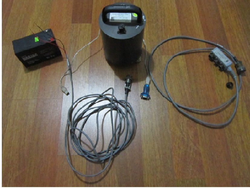
Şekil 2.1: Mikrotremor Ölçüm Cihazı ve Ekipmanları.
