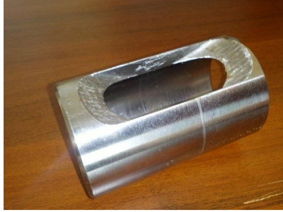
Şekil 29: Kılavuz kovanın imal edilmiş halde fotoğrafı
