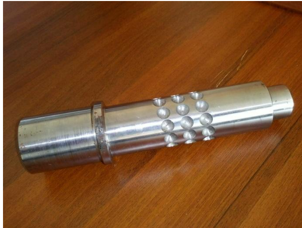
Şekil 24: Bilyeli sonsuz vidanın imal edilmiş halde fotoğrafı
