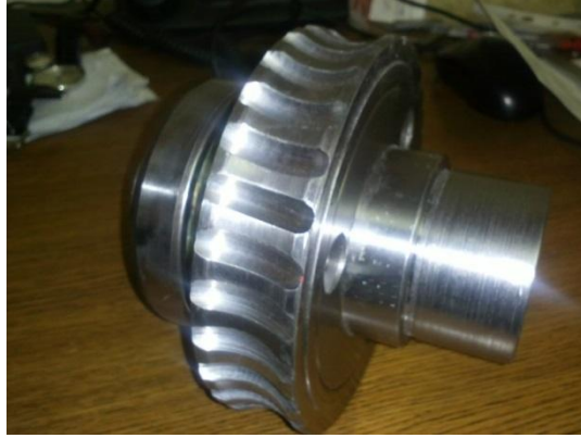
Şekil 27: Karşılık dişlisinin imal edilmiş haldeki fotoğrafı
