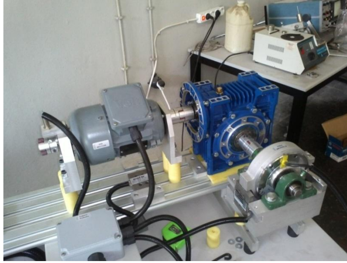
Şekil 33: 80 gövde sonsuz vida redüktörün deney düzeneğindeki görüntüsü
