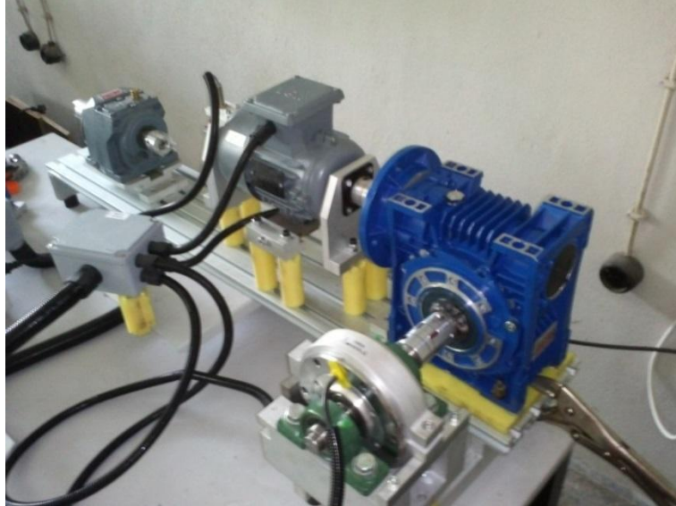
Şekil 36: 80 gövde bilyeli sonsuz vida redüktörün deney düzeneğindeki görüntüsü
