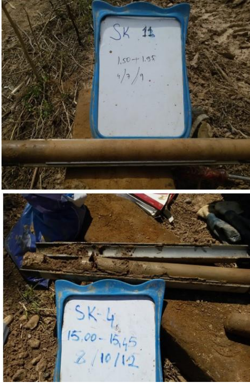
Şekil 5. Sondaj çalışmaları ile elde edilmiş zemin örneklerinin görünüşleri
