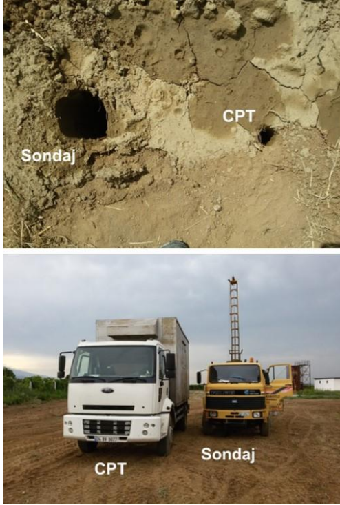
Şekil 2. Yapılan sondaj ve CPT uygulama noktalarının yakınlığı örneklerinin temsil ediciliğinin artırılmasını sağlamıştır
