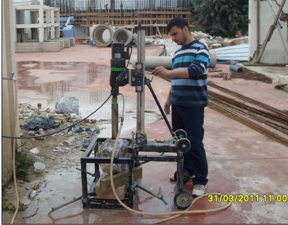
Şekil 5.11 : Bloktan karot alma işlemi
