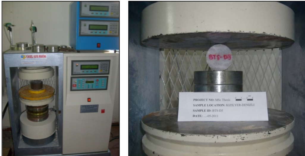
Şekil 5.35 : Dolaylı çekme dayanımı deney düzeneği ve numunenin yük altındaki konumu
