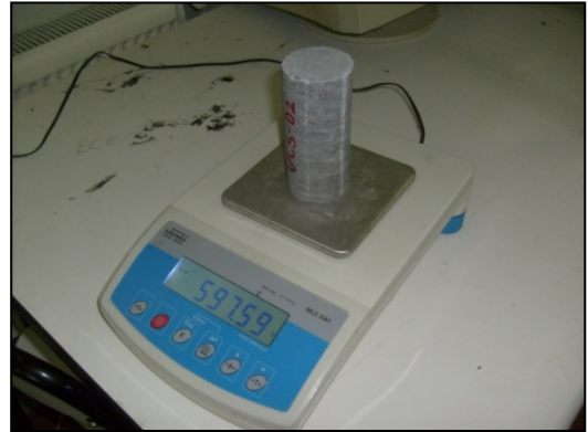
Şekil 5.28 : Kayaç örneklerin tartılması
