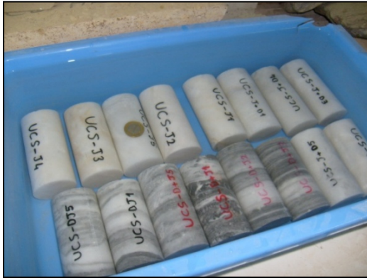
Şekil 5.27 : Örneklerin suda bekletilmesi
