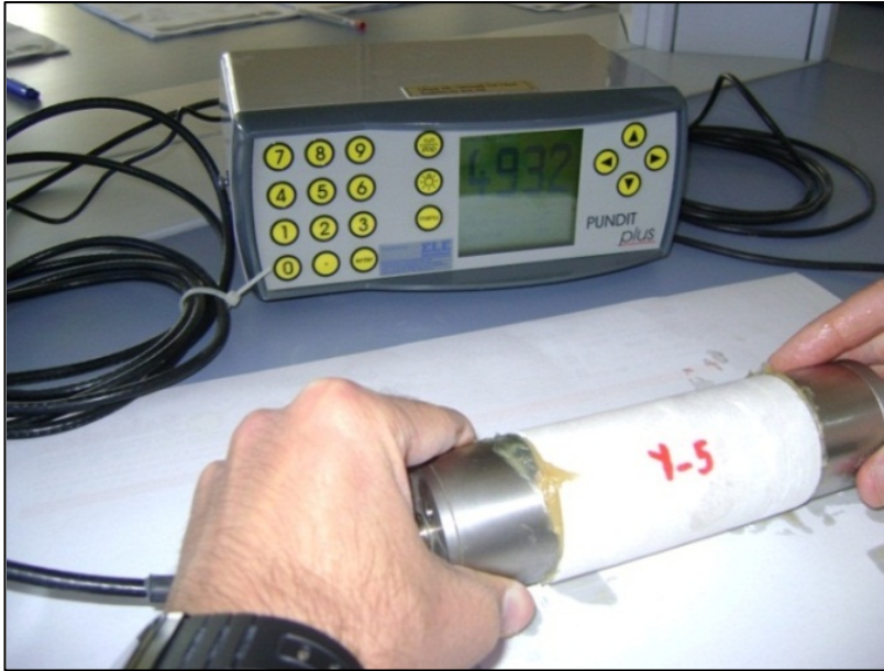
Őekil 5.31: Sonik hız deneyi için kullanılan Pundit Plus CNS Farnell cihazı
