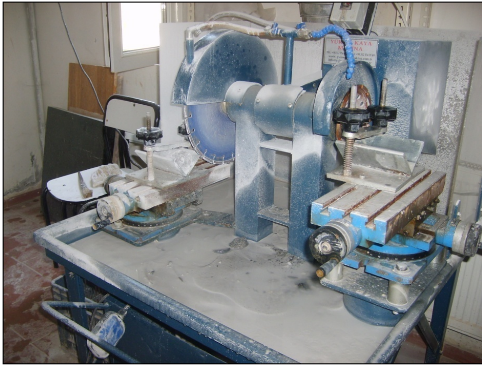
Şekil 5.12 : Karot kesme makinesi
