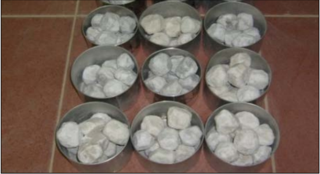
Şekil 5.38 : Suda dağılmaya karşı duraylılık indeks deneyi numuneleri
