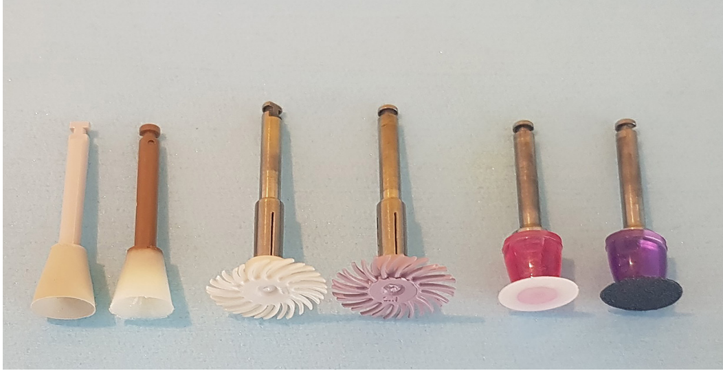
Resim 1. Çalışmada kullanılan bitirme ve cilalama uçları (soldan sağa doğru sırasıyla); EnhancePoGo Cilalama Silindiri (EPCS), Enhance Bitim Silindiri (EBS), Sof-Lex Spiral Bitim Lastiği (SSBL), Sof-Lex Spiral Cilalama Lastiği (SSCL), Super-Snap Rainbow Süper-Cilalama Diski (SRCD), Super-Snap Rainbow Bitim Diski (SRBD)
